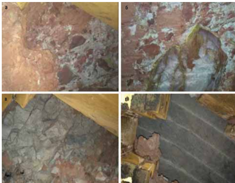
Рис. 9. Вариации состояния валунов: а – скальный фрагмент в глине, б – валун во вмещающей глине, в – трещиноватый валун, г – массивный валун большого размера
