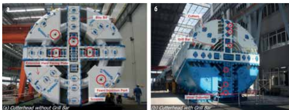
Рис. 6. Конструкция режущего органа для проходки в валунах: а – без колосников, б – с колосниками
