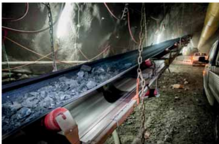
Рис. 9. Конвейерная откатка породы
