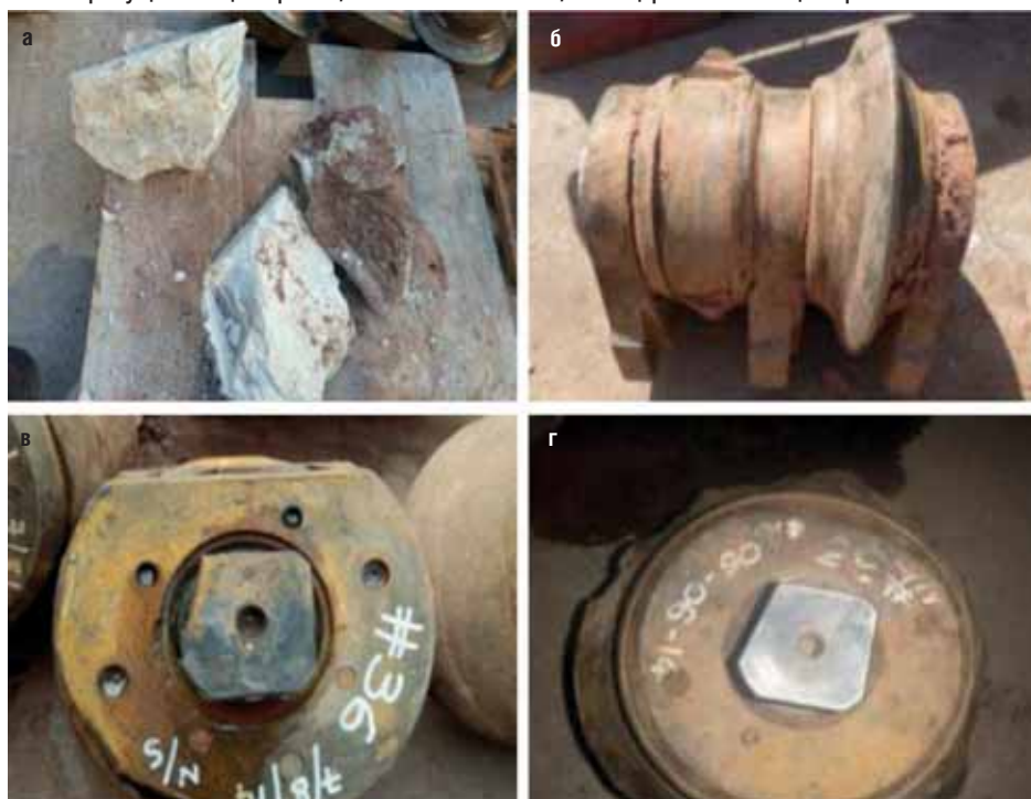
Рис. 10. Виды повреждений режущего инструмента: а – кусок после шнекового транспортера, б – разрушенное режущее кольцо шарошки, в – износ по плоскости, г – выщербленное кольцо шарошки
