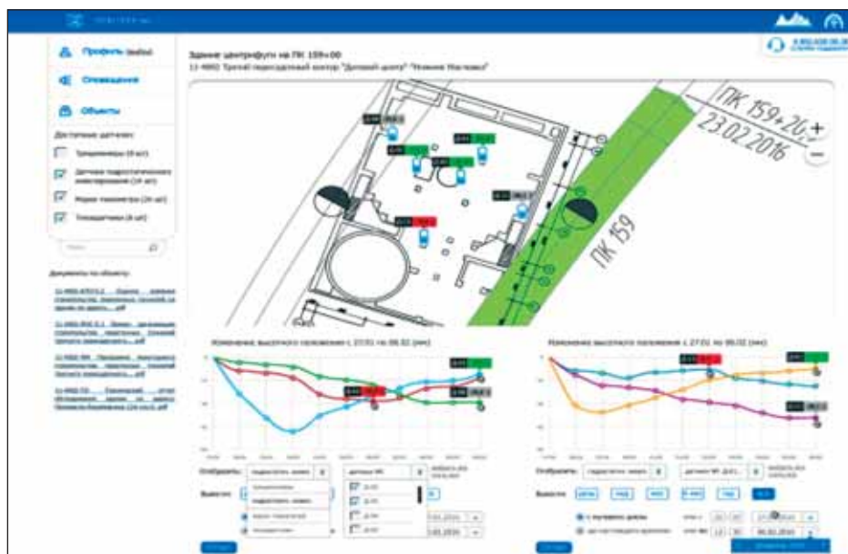
Рис. 6. Отображение информации по высотному положению фундамента через сеть интернет в программном комплексе Monitron.xyz
