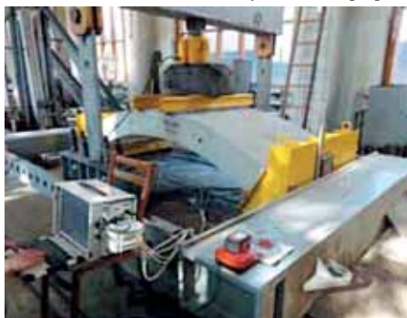
Рис. 3. Статические испытания высокоточных блоков обделки для ТПМК диаметром 10,82 м [22]
