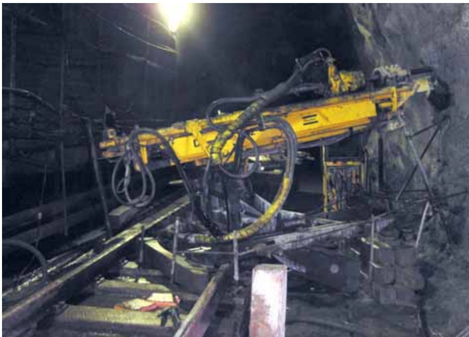
Рис. 1. Бурение скважин станком горизонтального бурения ДИАМЕК-262
