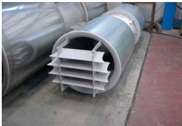
Рис. 1. Установка направляющего дефлектора
