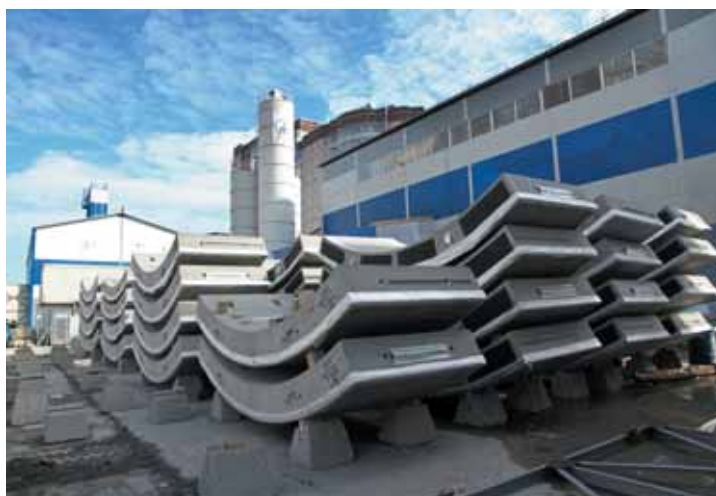
Высокоточная обделка для строительства двухпутного тоннеля
