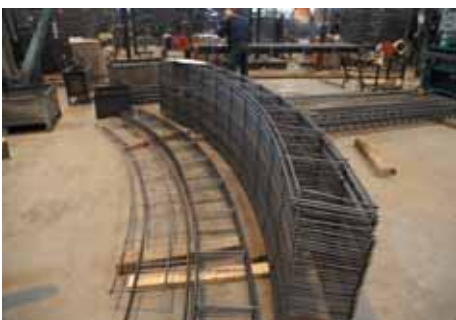
Криволинейные каркасы произведены на автоматической машине NNL
