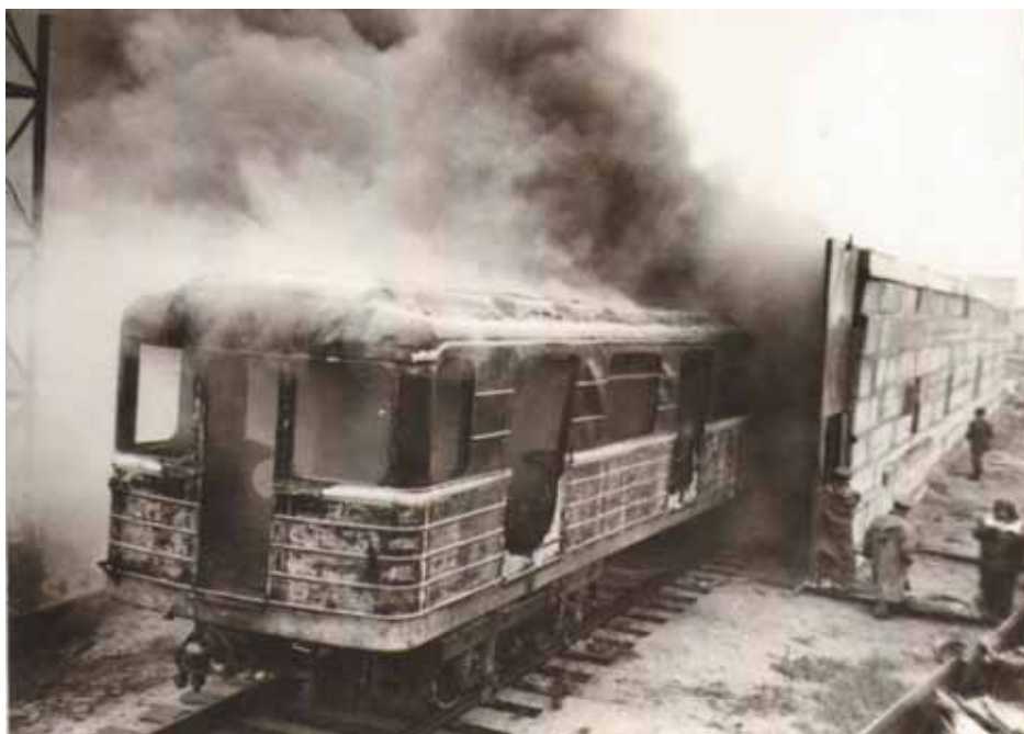
Рис. 1. Общий вид макета с подвижным составом при проведении огневого эксперимента
