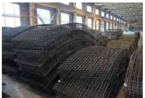
Склад готовых арматурных каркасов для тоннельной обделки
