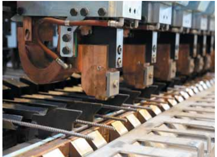
Мобильные сварочные головки машины Preflex (AWM)
