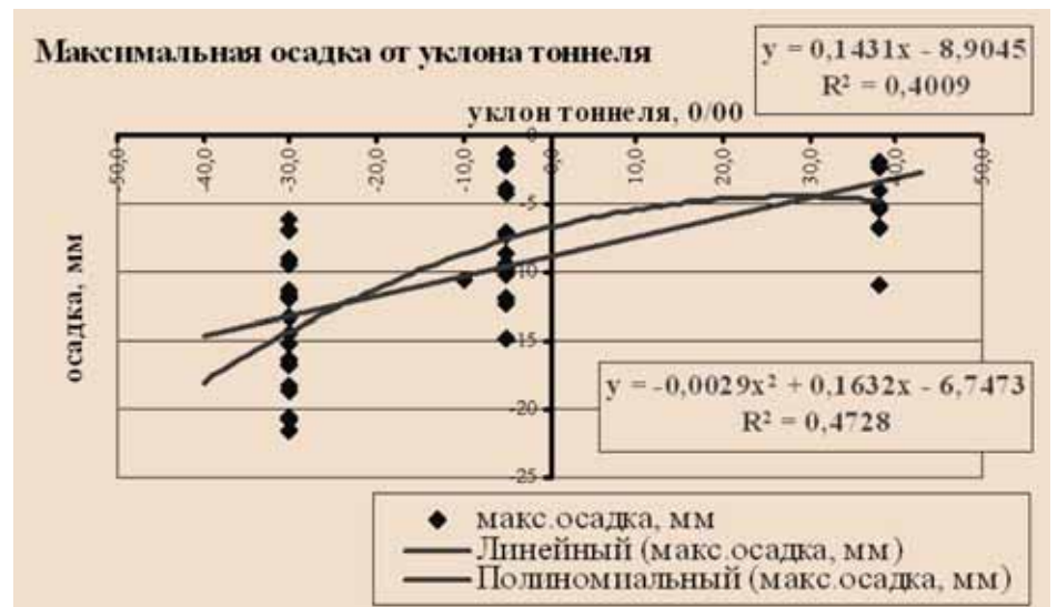
Рис. 2. Зависимости осадки в центре мульды от уклона тоннеля диаметром 14,2 м
