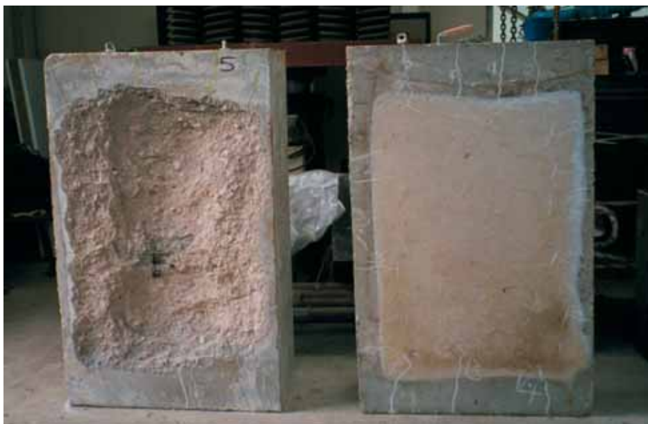
Рис. 10. Бетон после воздействия пожара
