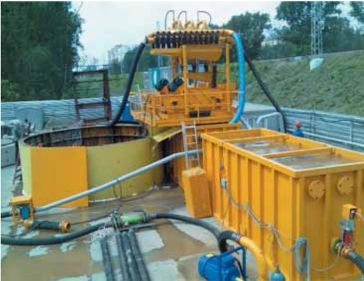
Рис. 5. Оборудование для сепарации грунта
