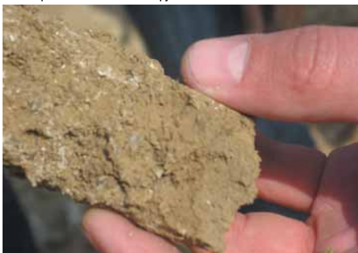
Рис. 2. Кристаллы соли в составе грунта
