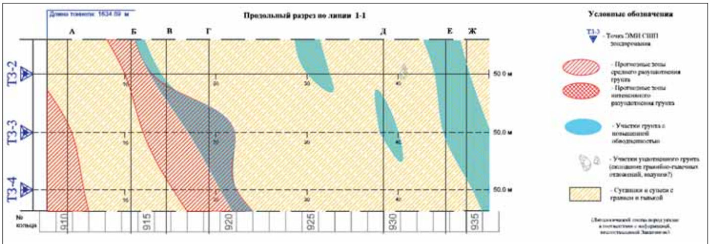
Рис. 2. Результаты прогноза инженерно-геологических и гидрогеологических условий впереди забоя тоннеля
