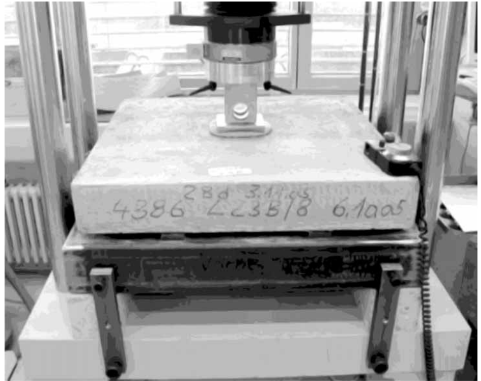
Рис. 1. Проведение испытаний квадратных плит по SIA 162/6
