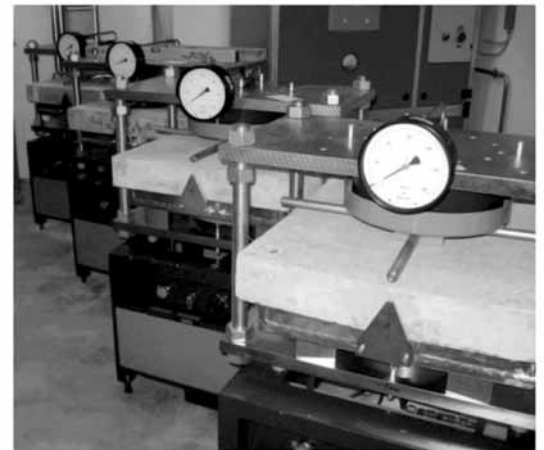
Рис. 2. Испытание квадратных плит на ползучесть под действием статической нагрузки
