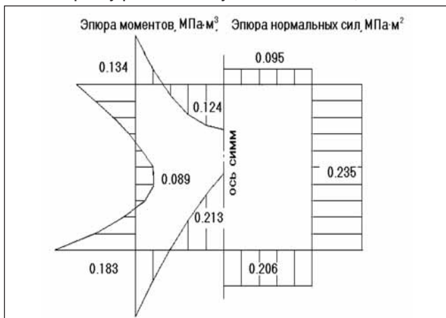
Рис. 4. Эпюры внутренних сил, полученные по модели ЦНИИСа
