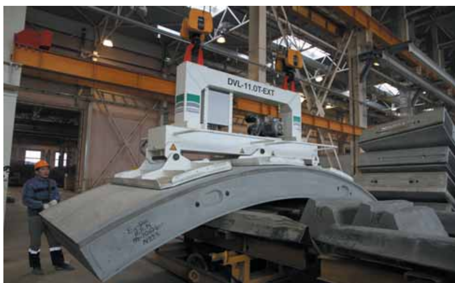
Погрузка тьюбинга. Завод Метробетон
