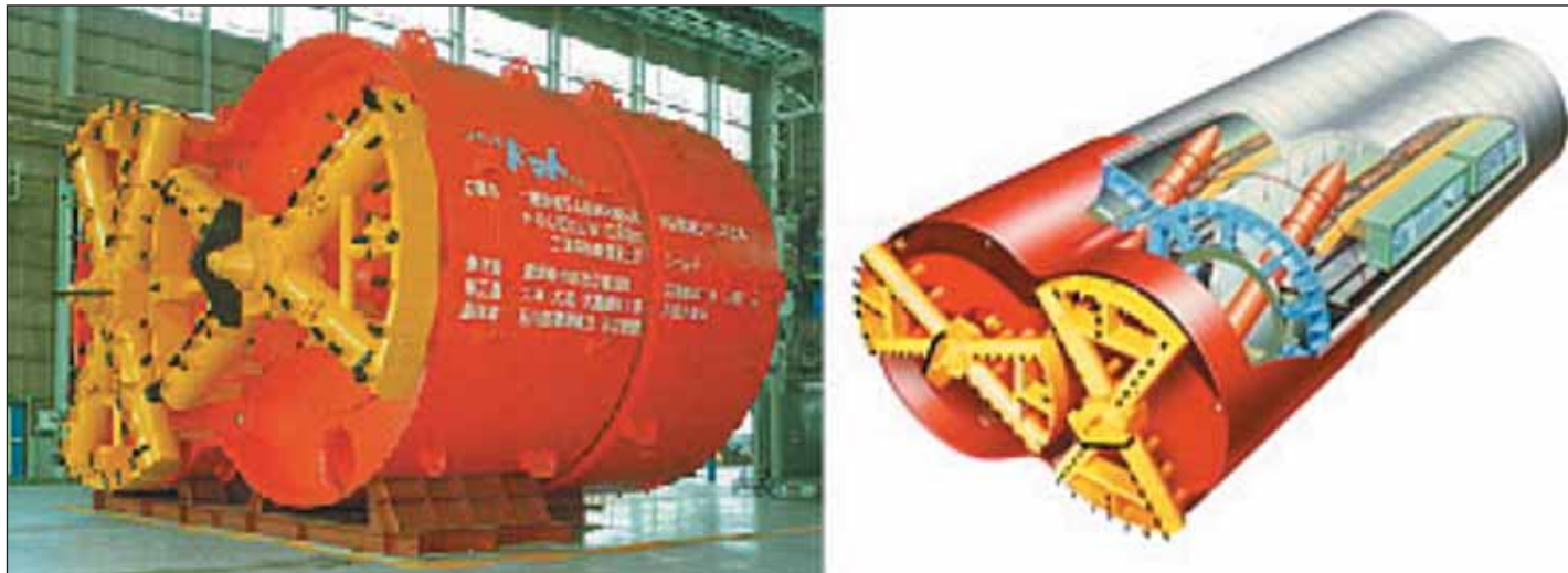
Рис. 1. Тоннелепроходческий комплекс DOT для сооружения перегонных тоннелей на линии метро Astram в городе Хиросима
