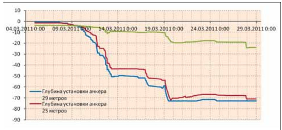
Рис. 7. Кривые формирования деформаций массива по одной из скважин, отражающие все операции технологического цикла
