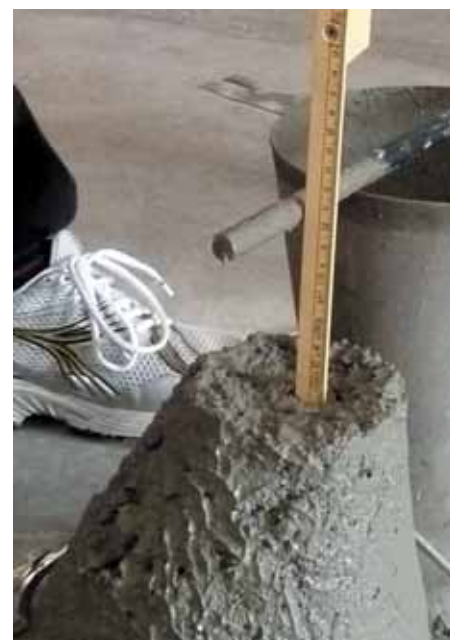
Рис. 5. Осадка конуса (определение подвижности бетонной смеси). Слева – бетонная смесь без фибры, справа – добавление фибры из расчета 8 кг/м³
