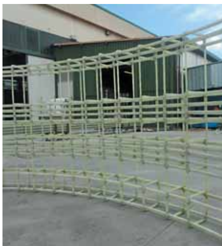
Рис. 3. Пространственный каркас для армирования блоков высокоточной обделки
