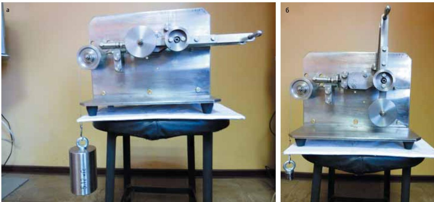
Рис. 8. Демонстрационная модель нажимного устройства, построенная по схеме рис. 3
