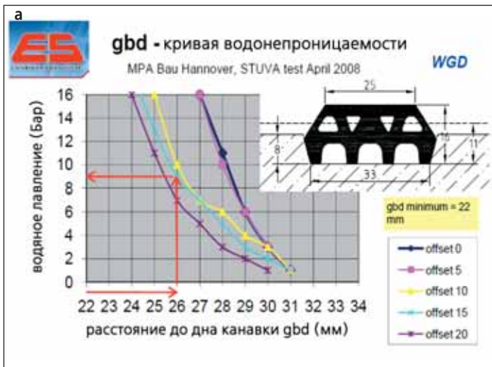
Рис. 6. Результаты испытаний профиля: а – шириной 33 мм; б – шириной 44 мм
