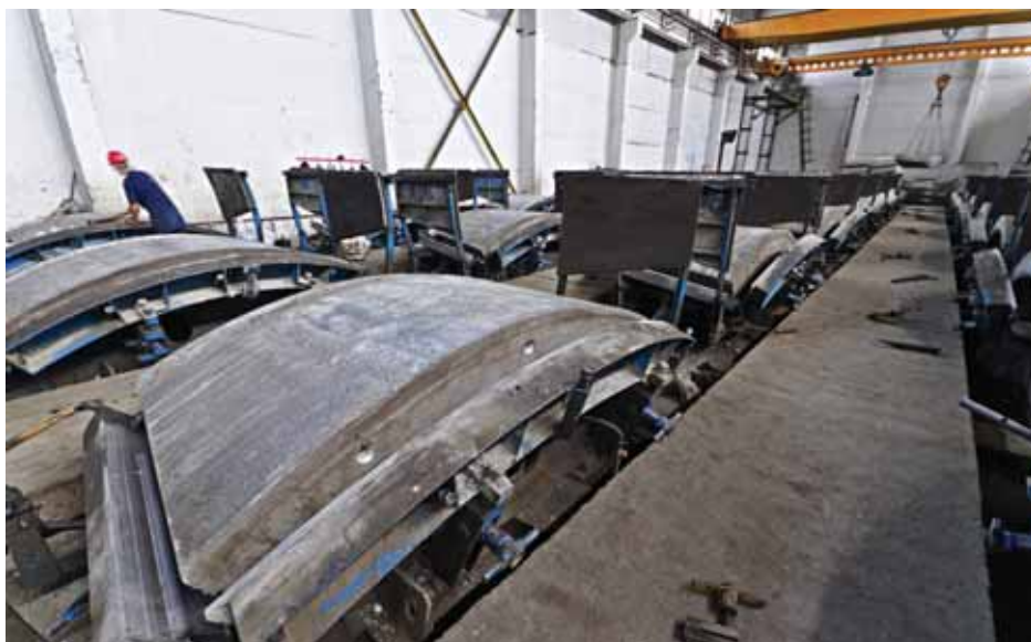
Железобетонная тоннельная обделка, изготовленная на производственном комбинате ПАО «Киевметрострой»
