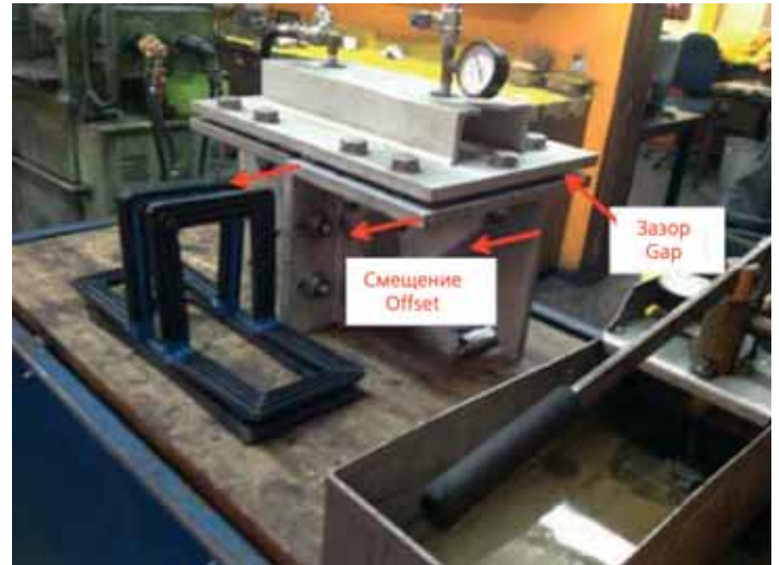
Рис. 5. Испытательный стенд для проведения тестов на водонепроницаемость уплотнителя
