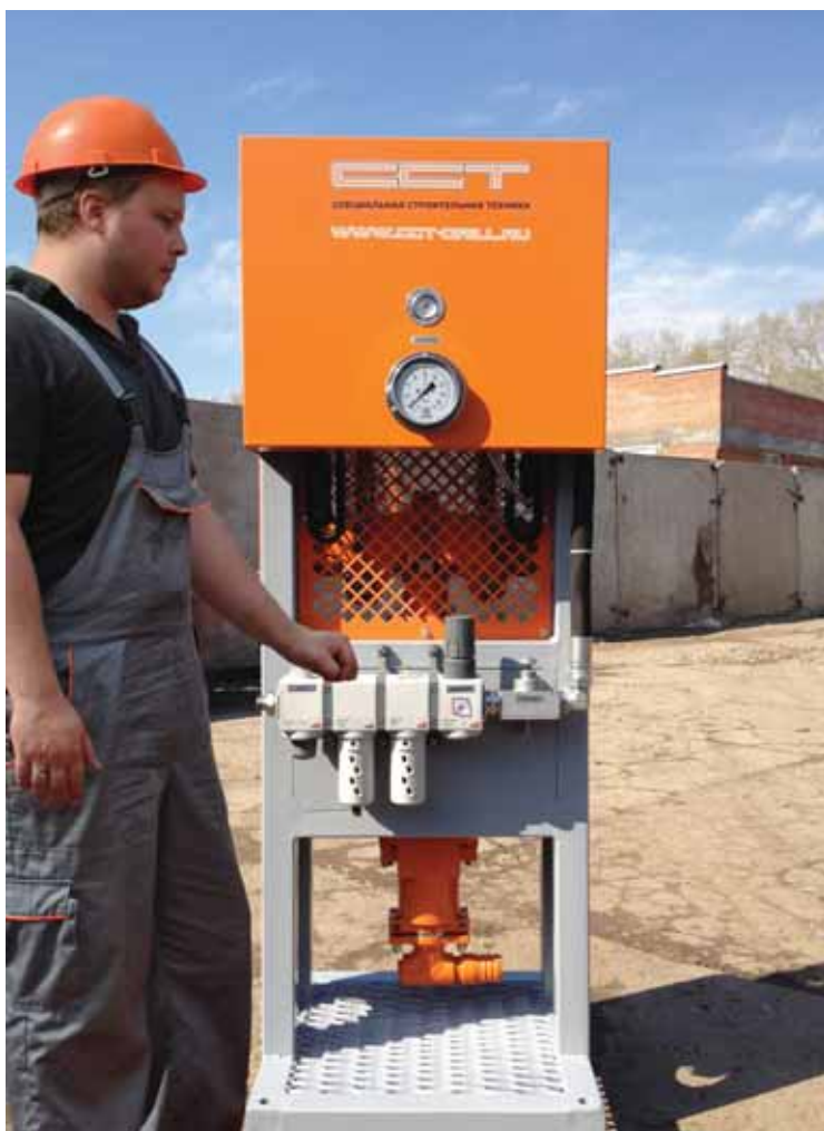
Рис. 2. Внешний вид инъекционного пневматического насоса GP-40
