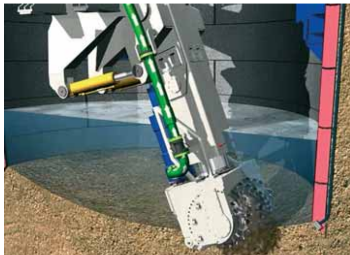
Рис. 4. Принцип работы проходческого комплекса VSM
