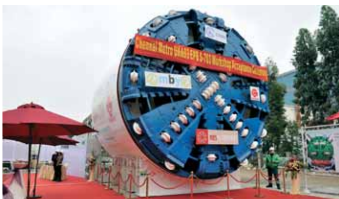
Рис. 7. ТПМК S-703 для проекта в Ченнаи перед заводской приёмкой
