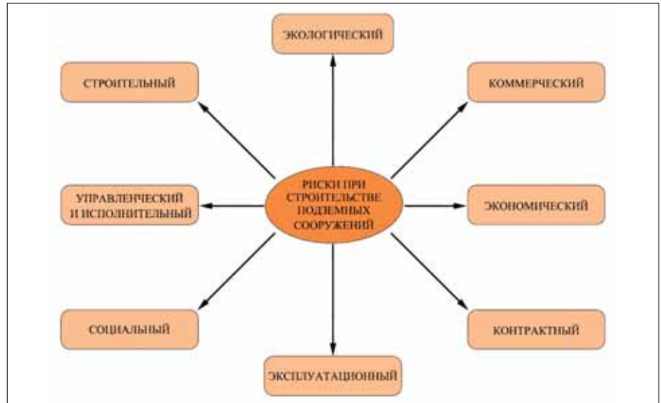
Рис. 2. Классификация рисков при строительстве подземных сооружений
