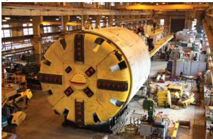
Проходческий щит КТПМ диаметром 5,6 м
