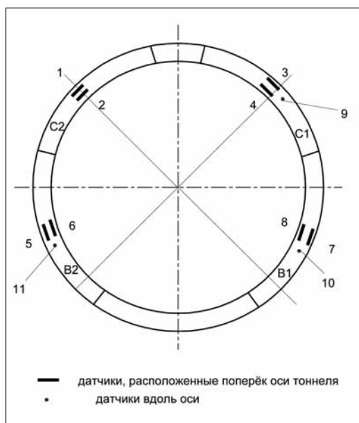
Рис. 6. Схема установки датчиков в обделке тоннелей
