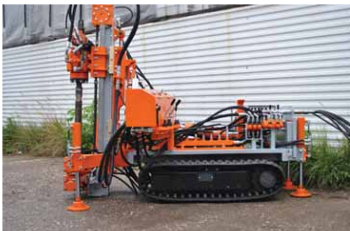
Рис. 2. Гусеничное шасси буровой установки Figaro Maschine FM T400
