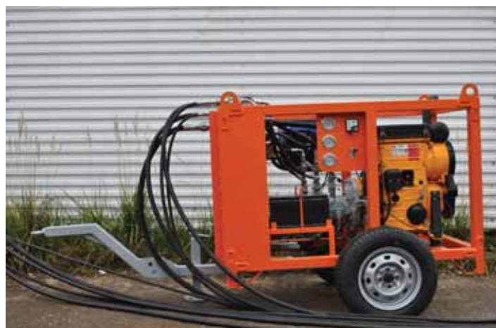
Рис. 3. Гидравлическая станция с дизельным двигателем Hatz (Германия)
