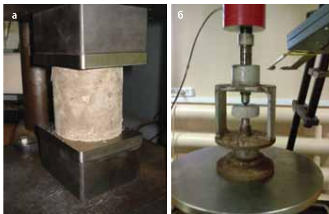
Рис. 6. Определение прочности образцов: а – на сжатие; б – на растяжение
