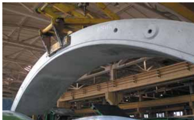
Рис. 2. Блок, на 100 % армированный синтетической фиброй, для обделки вертикального шахтного ствола (Санкт-Петербург)
