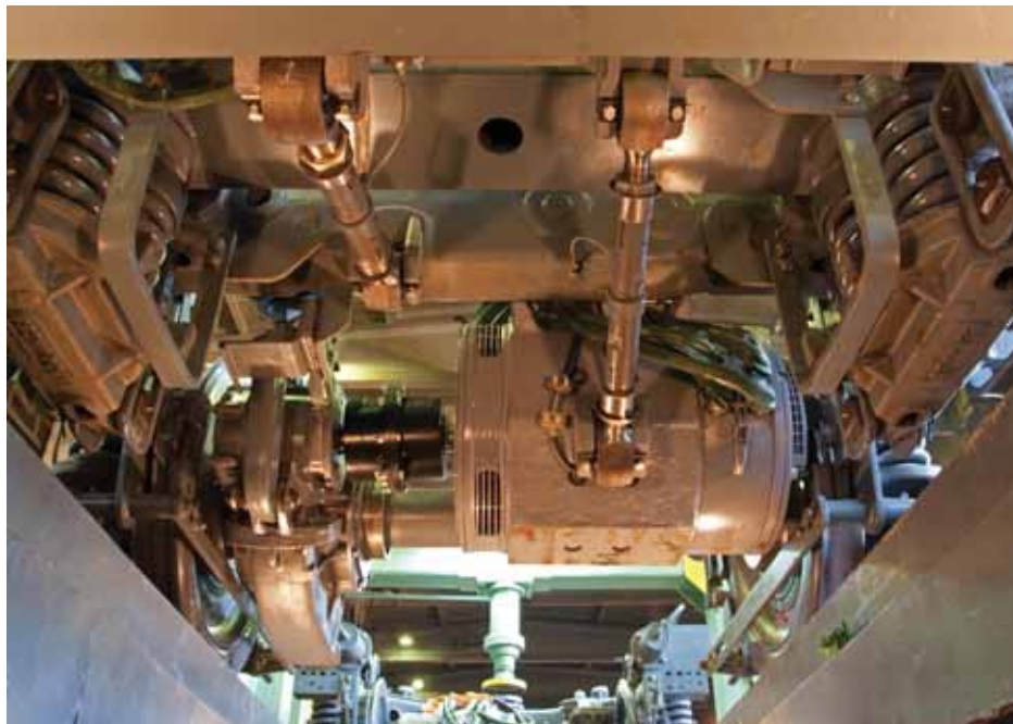
Тележка вагона метро производства ООО «НПЦ Система» (вид снизу)
