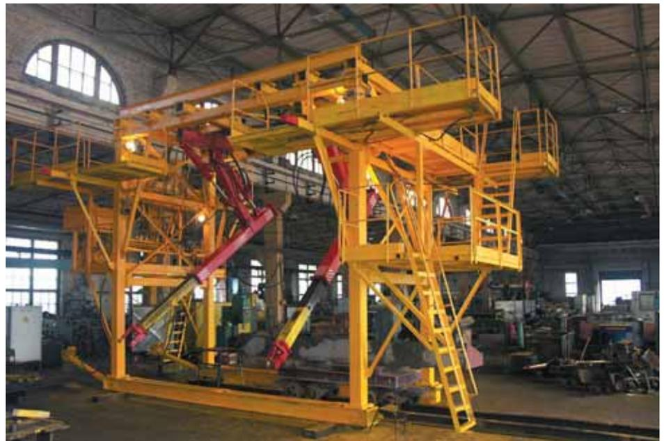
Рис. 4. Установщик ПМБ механических балок
