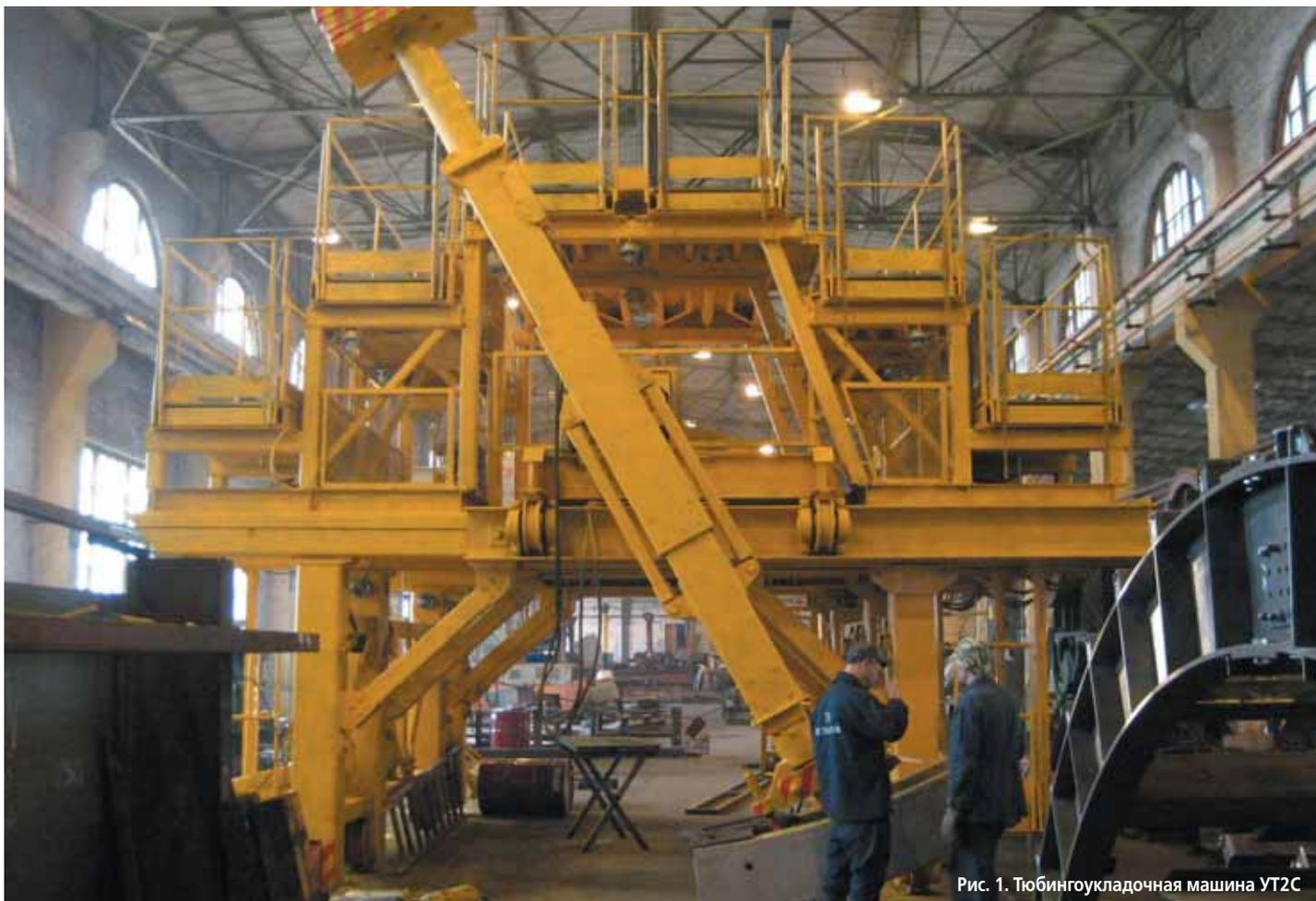
Рис. 1. Тюбингоукладочная машина УТ2С
