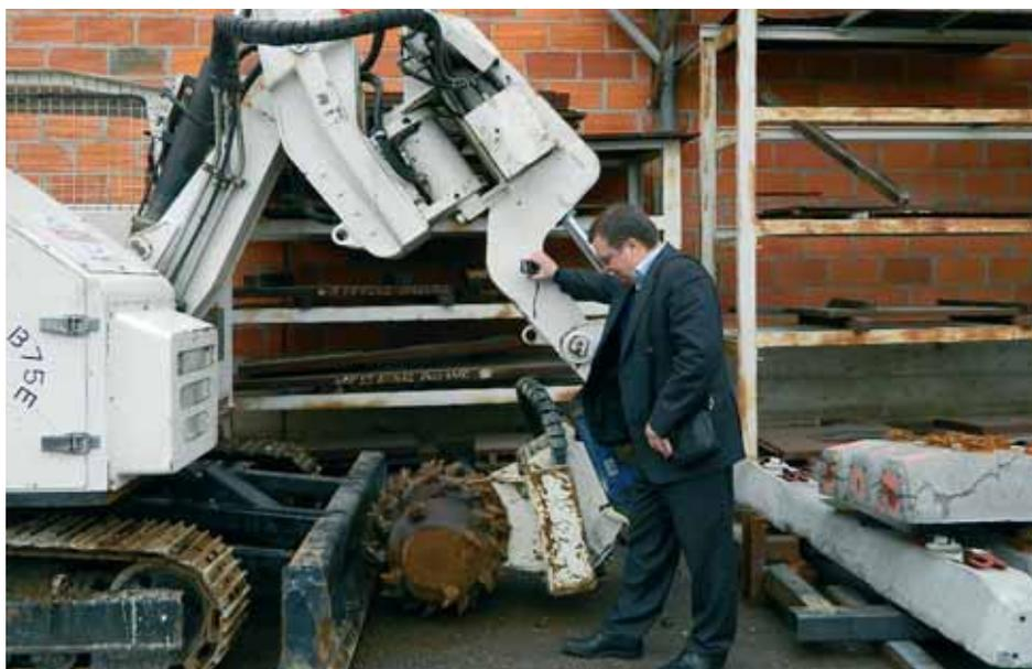
Малогабаритная роботизированная установка «Бутор» со сменным рабочим органом производства фирмы Metalliance
