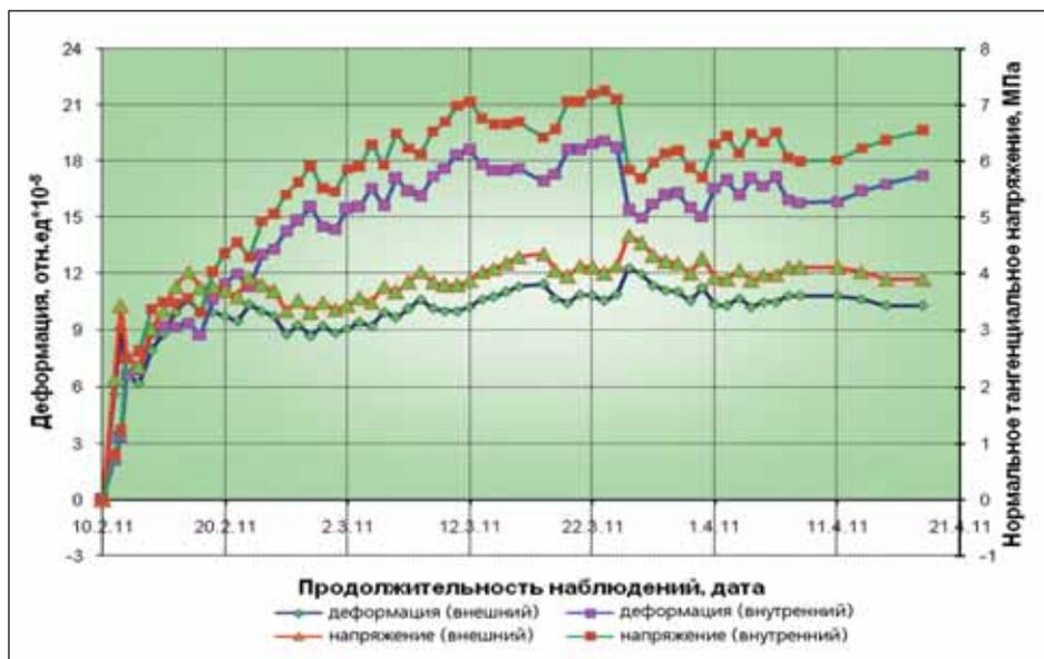
Рис. 3. Графики формирования напряженного состояния обделки
