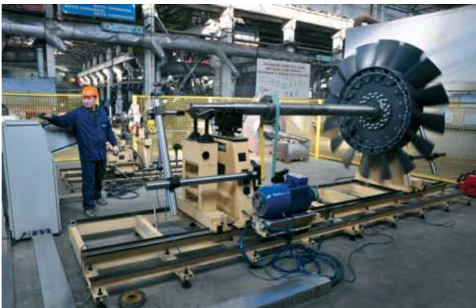
Рис. 8. Балансировка роторов
