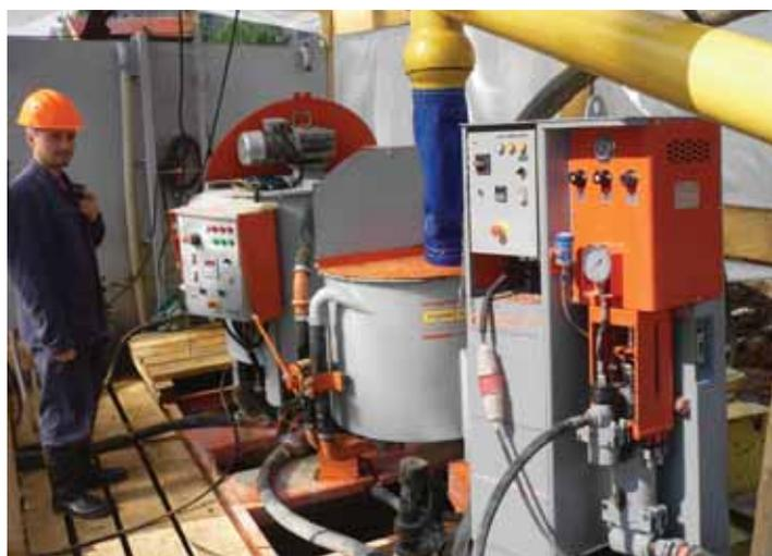
Рис. 3. Инъекционный комплекс на объекте предприятия «ИнжПроектСтрой»
