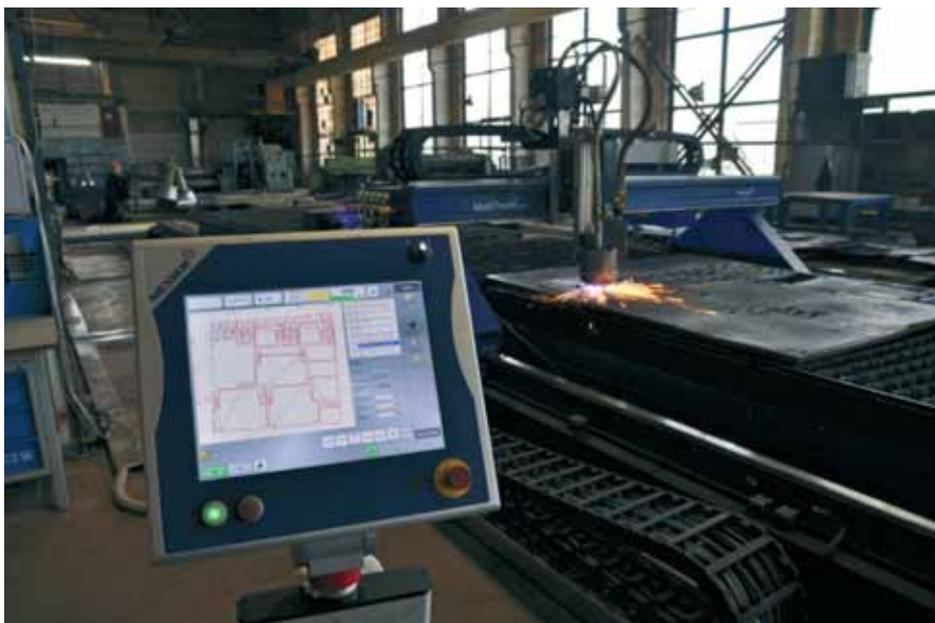
Рис. 6. Установка плазменной резки
