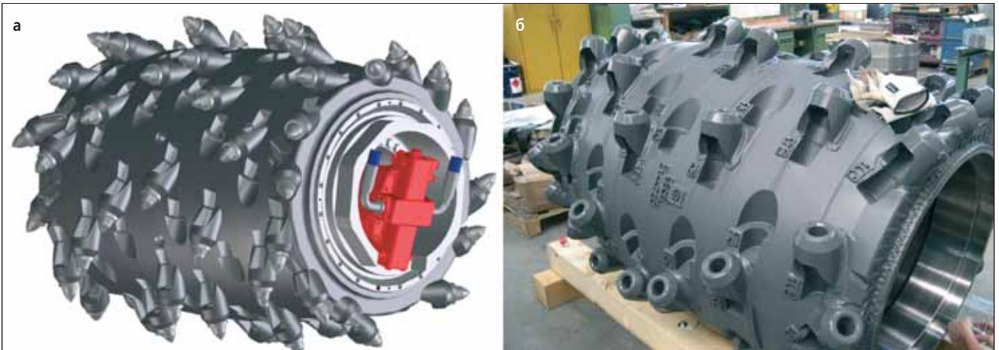
Рис. 2. Виды фрезы: а – с полным комплектом резцов; б – с возможностью комплектации разными инструментами
