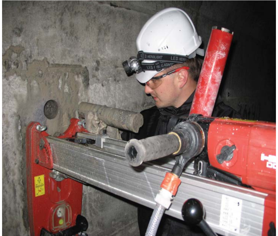
Рис. 1. Определение НДС обделки методом разгрузки
