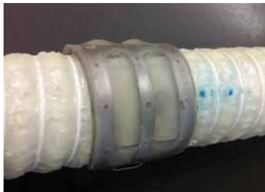
Рис. 6. Гофрированные трубы из стекловолокна с клапанами
