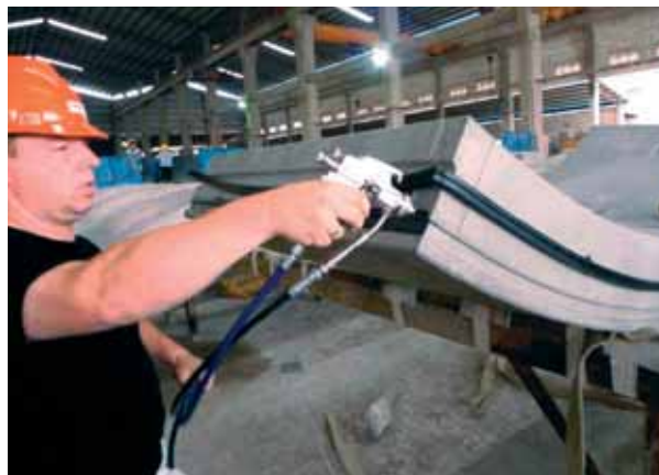
Рис. 5. Процесс наклеивания уплотнителей с использованием пульверизатора
