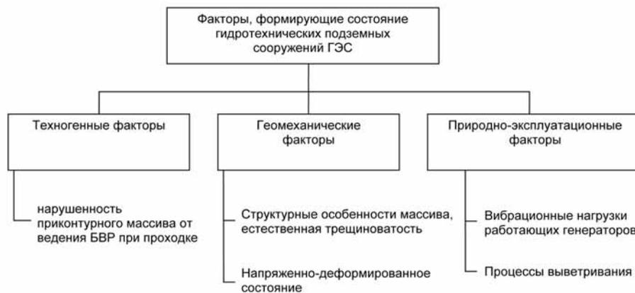
Рис. 1. Структура факторов, влияющих на состояние подземных сооружений
