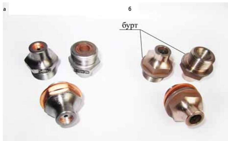
Рис. 3. Внешний вид стандартной форсунки (а) и с круговым буртом (б)
