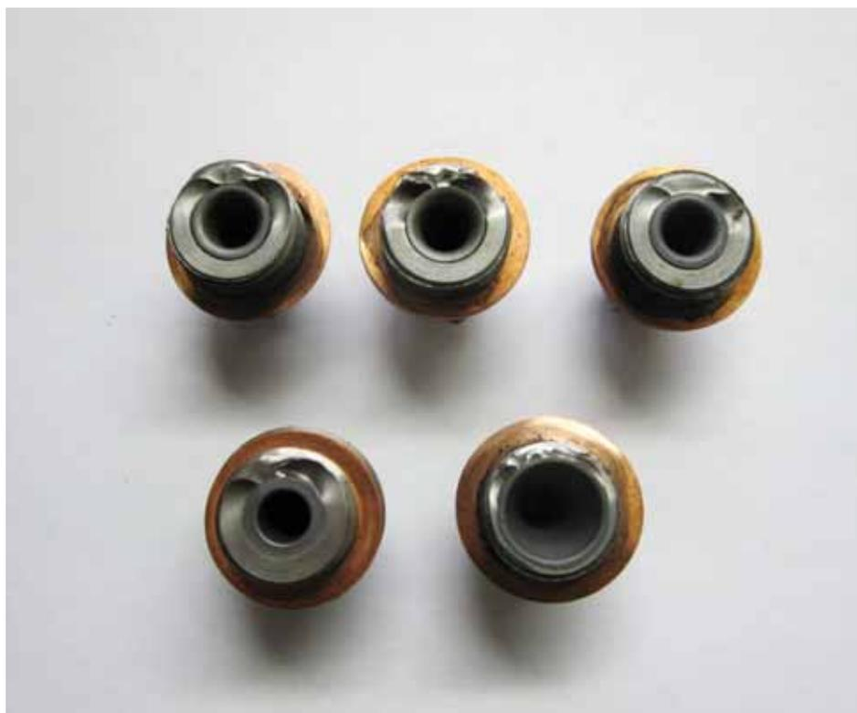
Рис. 7. Износ корпусов форсунок после промышленных испытаний
