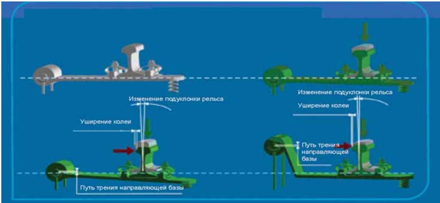
одной стороны от рельса, а вертикальная – пружиной, размещенной с противоположной стороны. Рельс установлен на рычаге, его траектория движения определена, и уширения колеи не происходит даже при больших вертикальных перемещениях.
