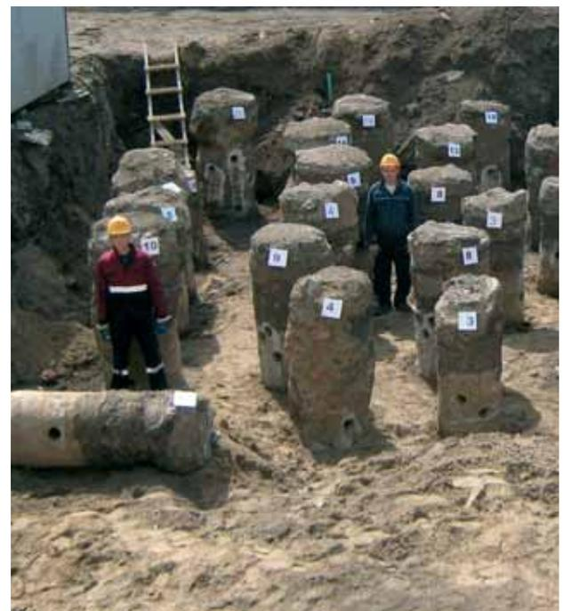
Рис. 5. Опытные грунтоцементные колонны
