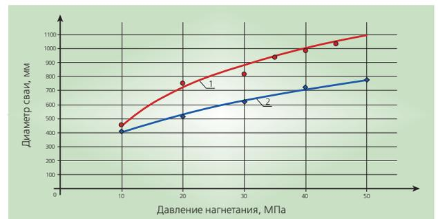
Рис. 3. Зависимость диаметра грунтоцементных свай от давления нагнетания цементного раствора: 1 –  $C=1$  кПа; 2 –  $C=7$  кПа
