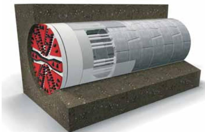
Рис. 1. ТПМК со сборной железобетонной обделкой
