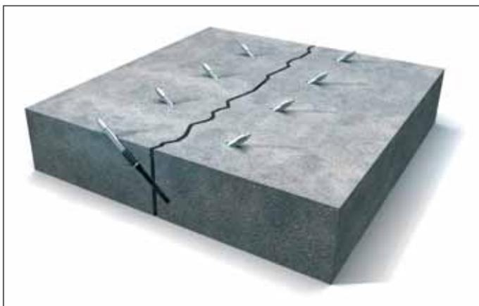
Рис. 6. Схема расположения пакеров
