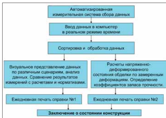
Рис. 5. Блок-схема мониторинга НДС тоннеля
