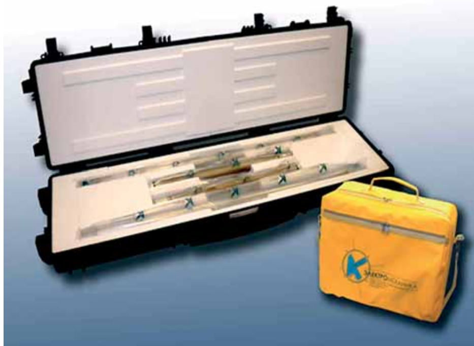
Рис. 1. Универсальный гироскопический инклинометр УГИ-42.03
