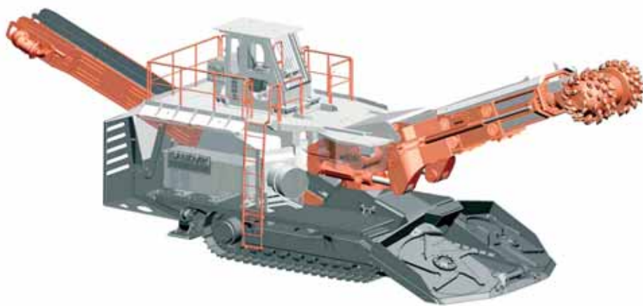
Тоннелепроходческий комбайн SANDVIK MT520
