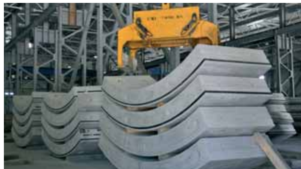
На заводе по изготовлению железобетонной обделки
