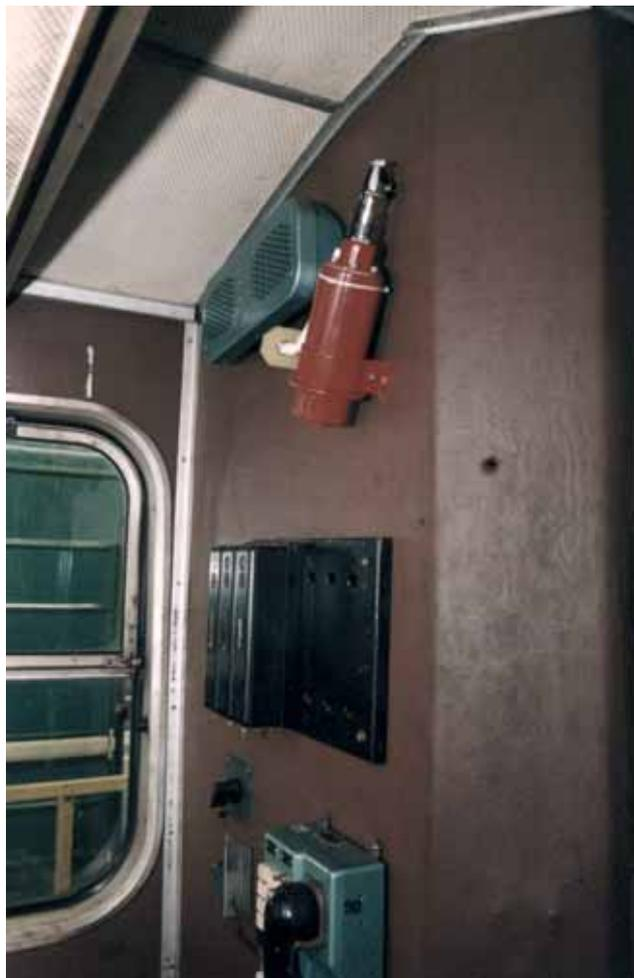
Автоматическая противопожарная система «ИГЛА»
