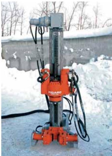
Рис. 1. Внешний вид буровой установки Figaro Maschine FM-400
