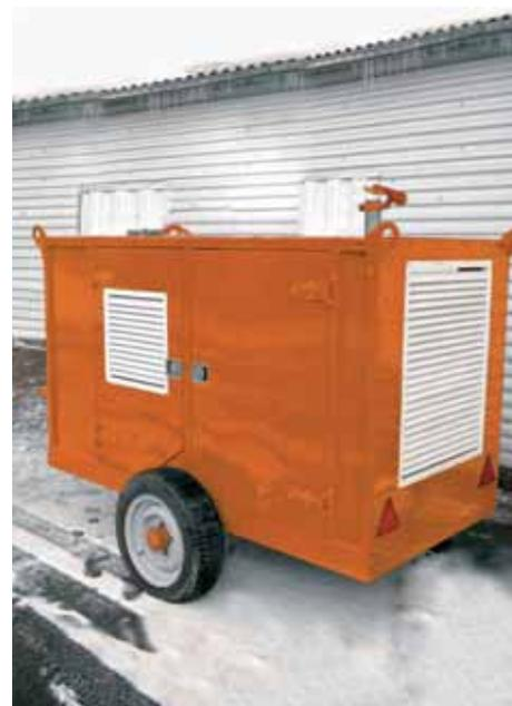
Рис. 2. Силовая гидравлическая станция на основе дизельного двигателя Д-243
