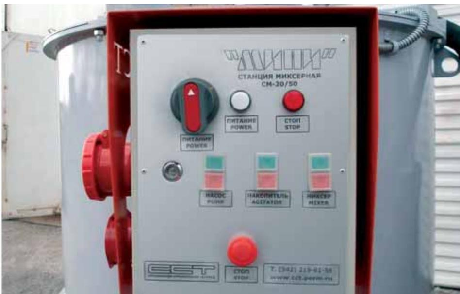
Рис. 6. Пульт управления миксерной станцией
