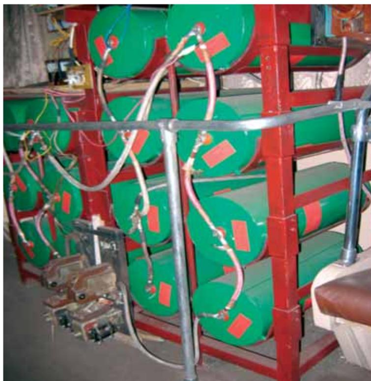
Рис. 1. Опытный образец конденсаторного накопителя энергии
