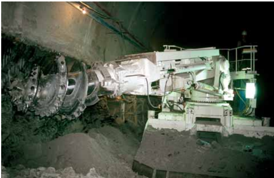
Разработка породы проходческим комбайном «Паурат Т 3.2»
