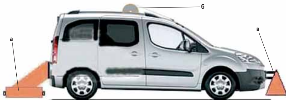
Рис. 2. Размещение автомобильной радиолокационной аппаратуры ТР-ГЕО: а – НЧ; б – видеокамера; в – ВЧ
