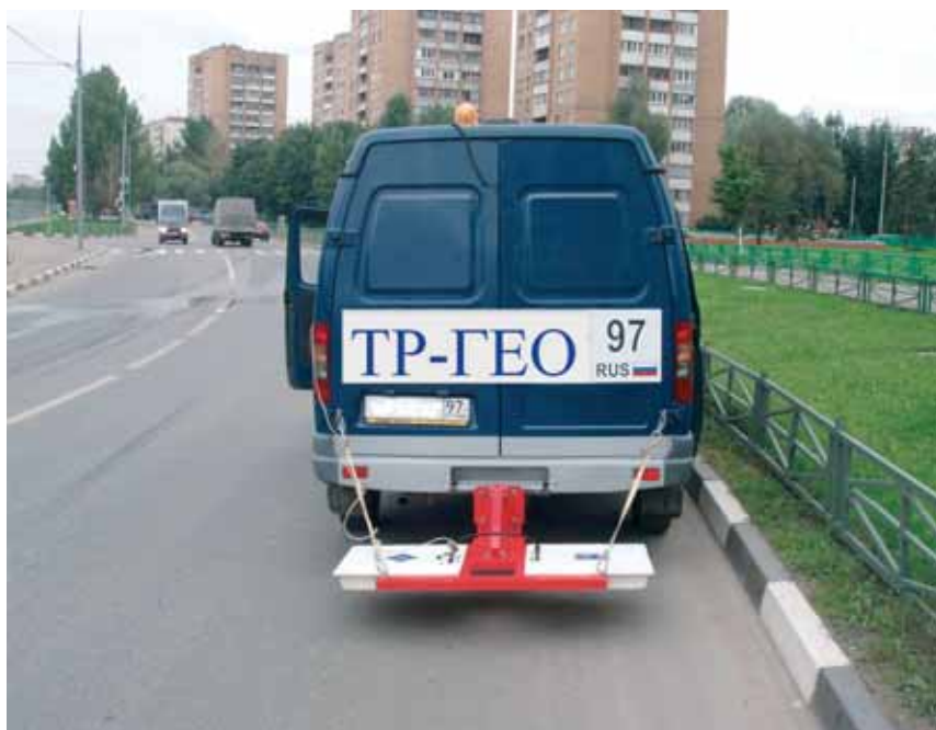
Рис. 3. Рабочий момент зондирования дорожного покрытия в составе автолаборатории на одной из улиц города Москвы
