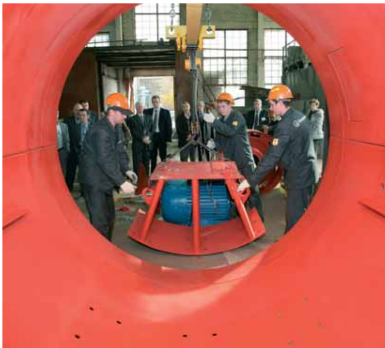
Рис. 6. Демонстрация монтажа элементов вентилятора в существующий корпус
