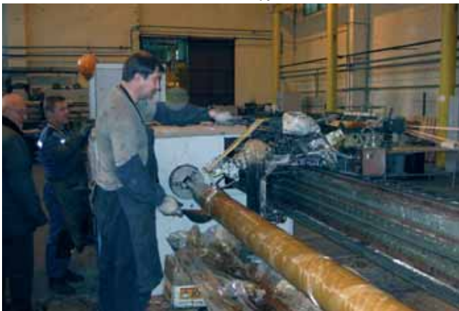
Рис. 2. Изготовление стеклопластиковых труб
