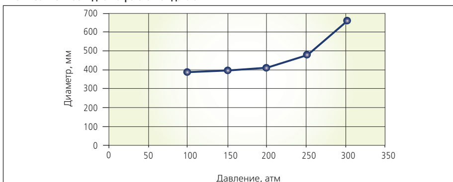
Рис. 4. Зависимость диаметра сваи от давления
