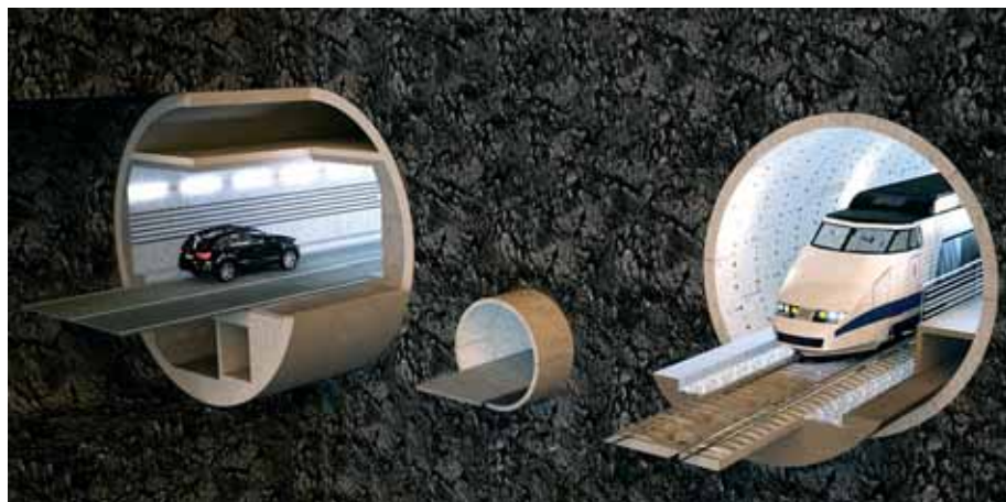
Трехмерная модель тоннельного комплекса № 3
