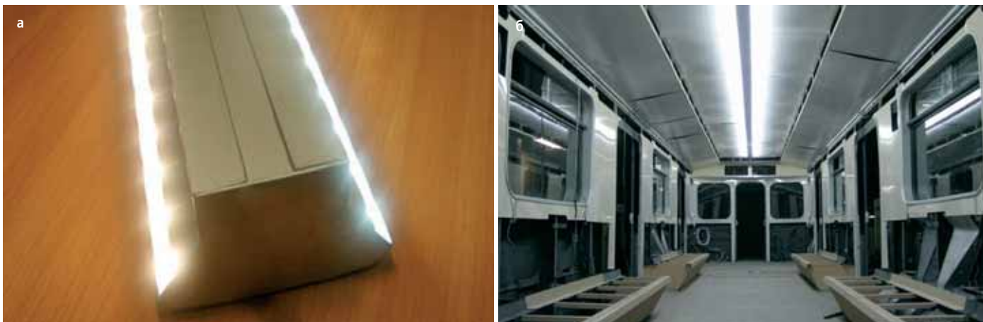
Рис. 6. Внешний вид (а) светодиодного модуля (ширина – 109 мм; высота – 56 мм;) и светодиодной линии (б) на отраженном свете
