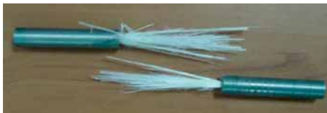
Рис. 4. Разрушенный образец при испытании на растяжение
