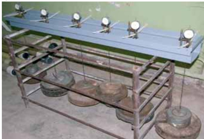
Рис. 5. Установка для проведения длительных испытаний на статический трехточечный изгиб
