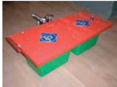
Рис. 7. Высокочастотный георадар ТР-ГЕО-04. Применяется для определения строения дорожной одежды
