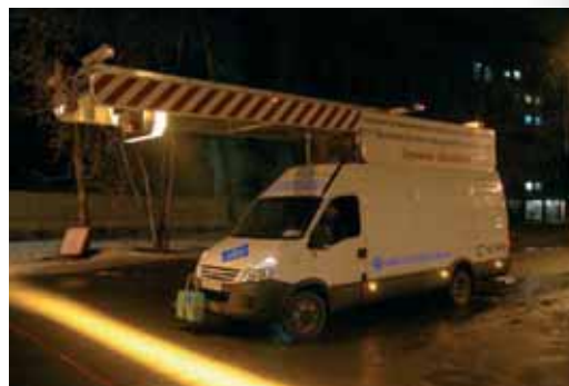
Рис. 9. Дорожные сканеры, оснащенные георадарами ТР-ГЕО
