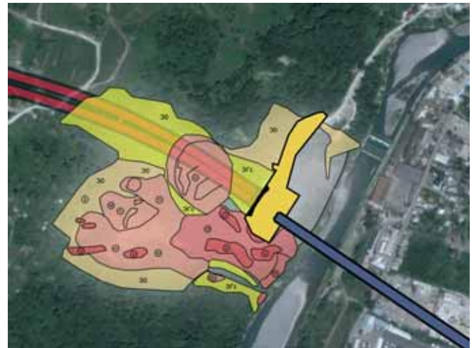
Оползневые процессы на Южном портале
