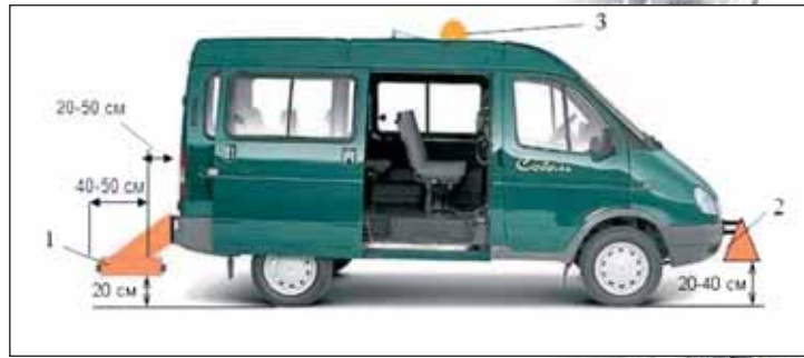
Рис. 6. Размещение антенн георадаров на автолаборатории: 1 – низкочастотного; 2 – высокочастотного; 3 – проблесковый маячок
