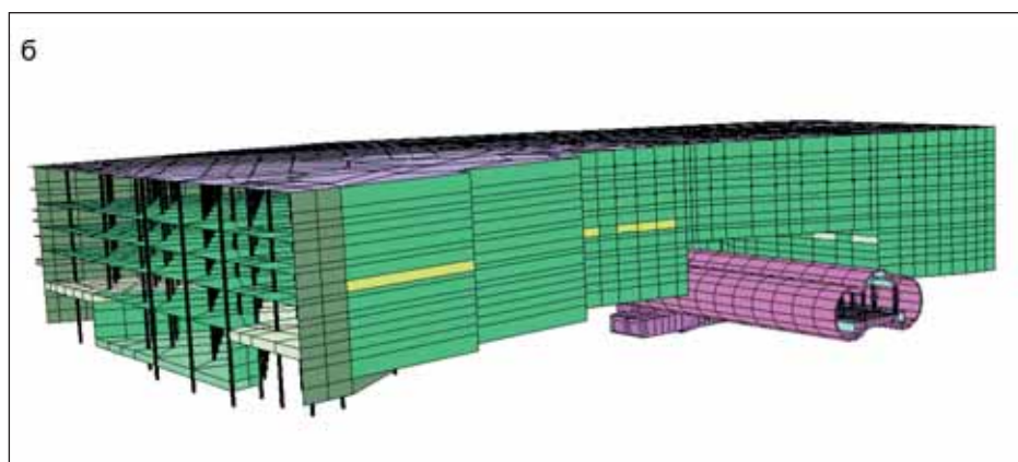
Рис. 1. Взаимное расположение строящегося многофункционального комплекса и существующей станции метрополитена: а – общий вид; б – расчетная модель
