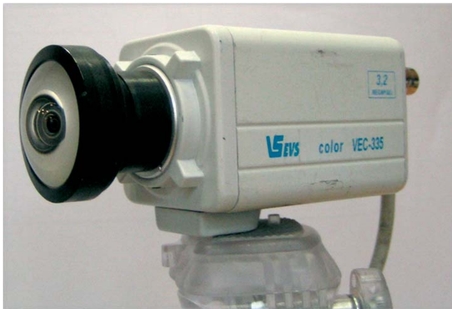
Рис. 3. Система видеонаблюдения с объективом «рыбий глаз»
