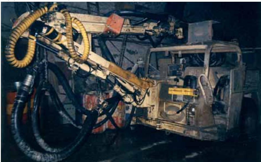
Торкретбетонмашина «Спреймек 6050В» финской фирмы «Нормет»
