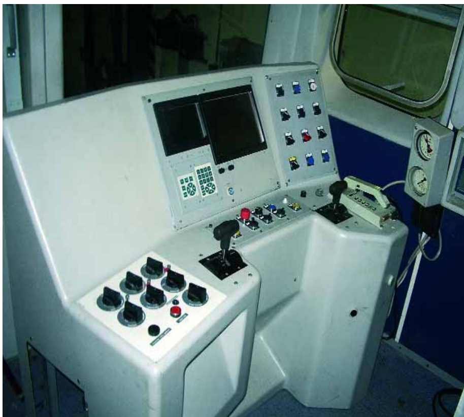
Пульт управления в кабине машиниста
