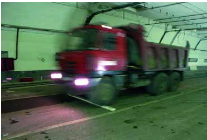
Рис. 8. Динамические испытания (проезд автомобиля через порожек)
