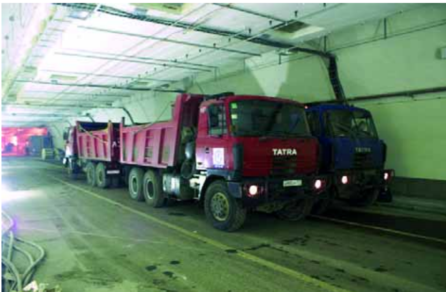
Рис. 7. Статические испытания (расположение автомобилей по схеме нагружений)
