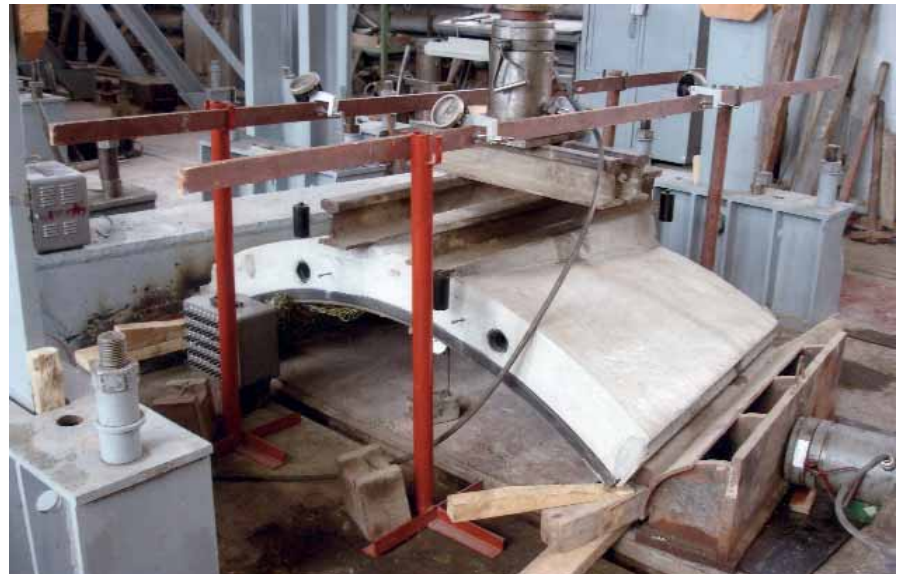
Стендовые испытания железобетонных блоков с полимерной футеровкой
