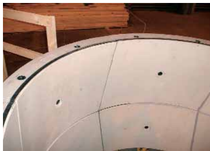
Контрольная сборка железобетонных блоков с полимерной футеровкой
