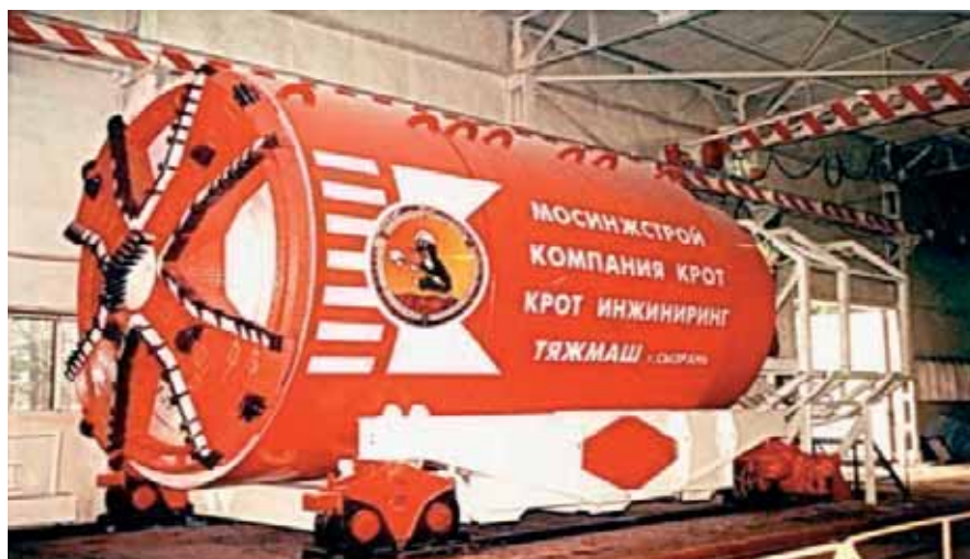
Рис. 1. Проходческий щит комплекса «Топаз» на стенде
