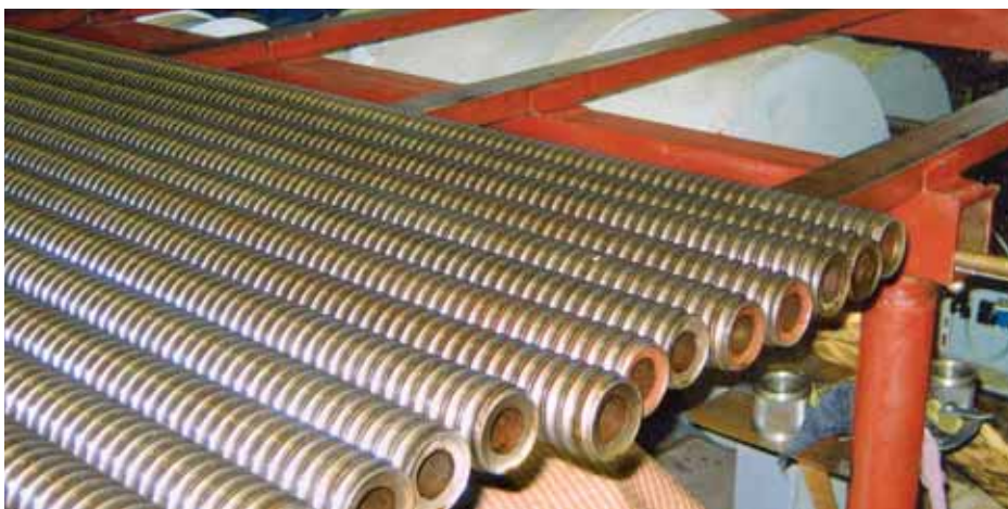
Рис. 3. Полая (трубная) холоднокатаная винтовая анкерная арматура на выходной решетке прокатного стана
