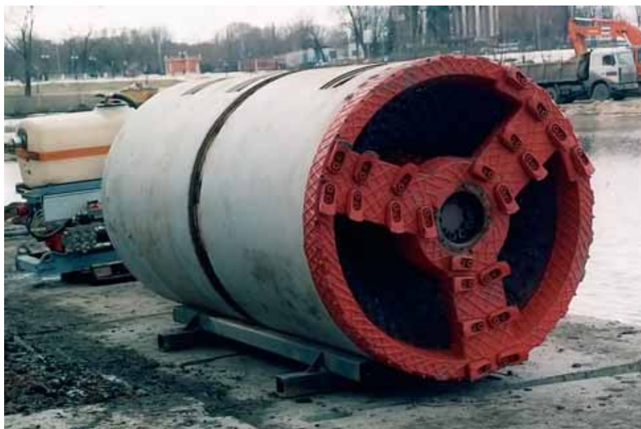
Рис. 1. Буровая головка микрощита
