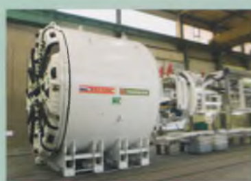
ТПМК для строительства Митинско-Строгинской линии, Москва
