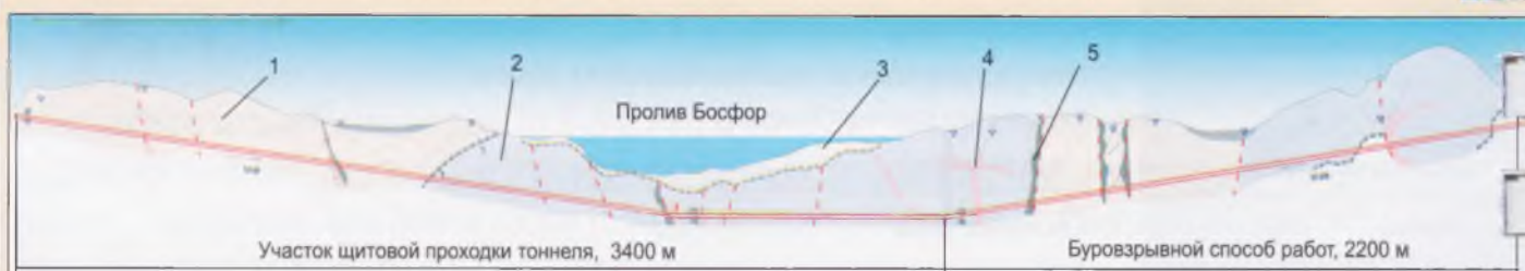
Геологический профиль трассы тоннеля под проливом Босфор:
