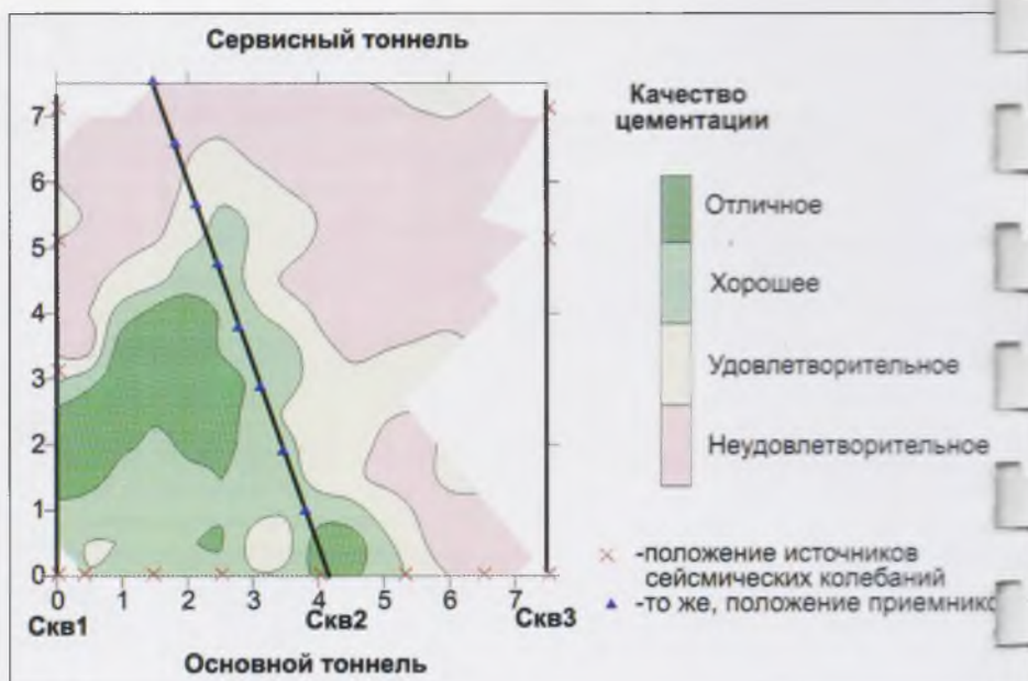
Рис. 6. Укрепление грунтов по сбойке № 3
