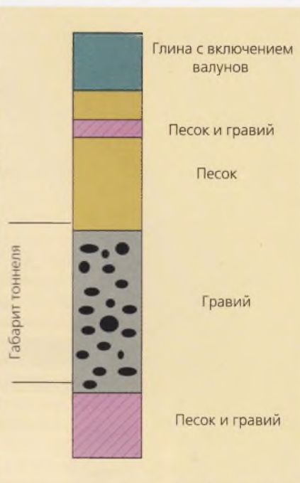
Рис. 2. Типичный геологический разрез вдоль трассы строящегося тоннеля
