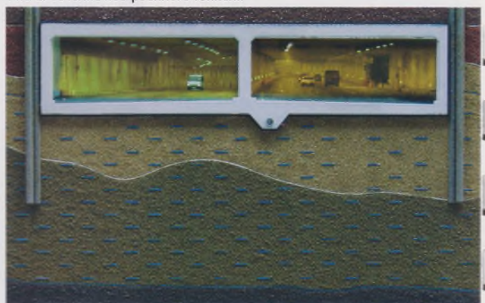
Рис. 2. Сечение построенного тоннеля
