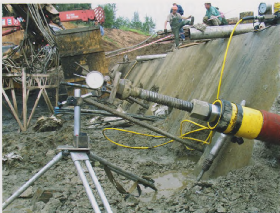
Рис. 4. Испытания пробного анкера из трубчатых винтовых штанг при строительстве Серебряноборского тоннеля
