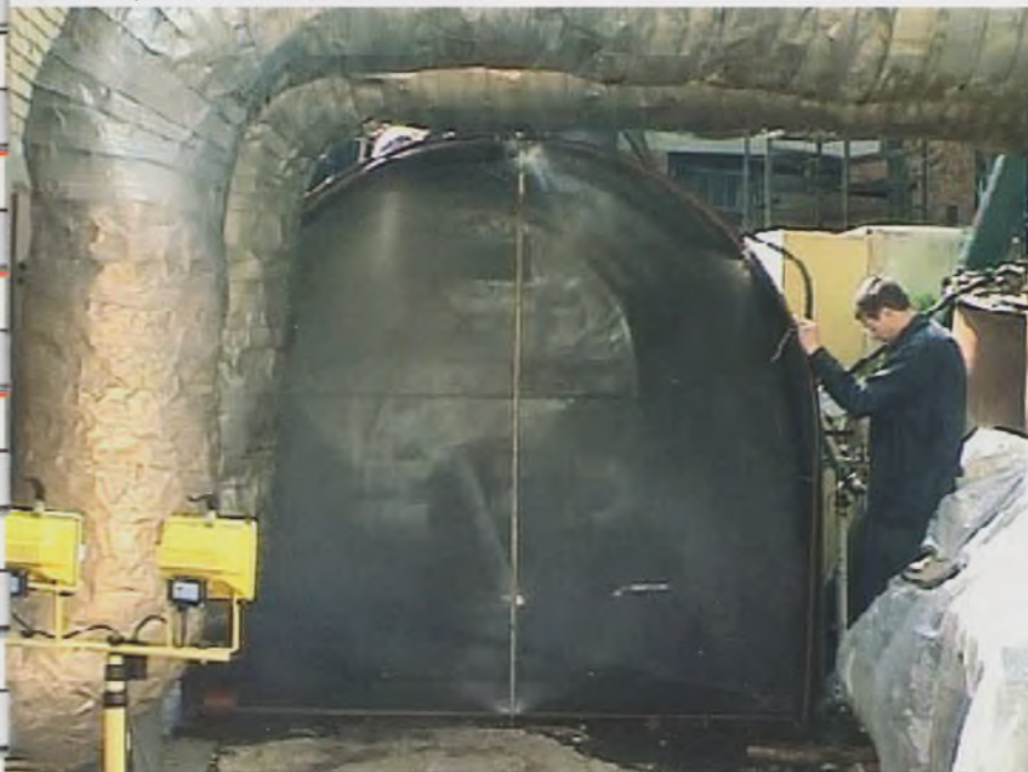
Рис. 2. Блокировка дыма в модельном тоннеле
