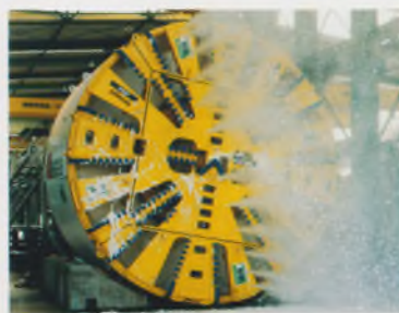
Щит с гидropriгрузом, Мадрид, Испания, \varnothing 9,33 м
