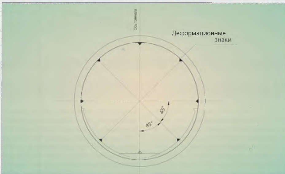
Рис. 3. Схема расположения деформационных знаков на обделке транспортного тоннеля
