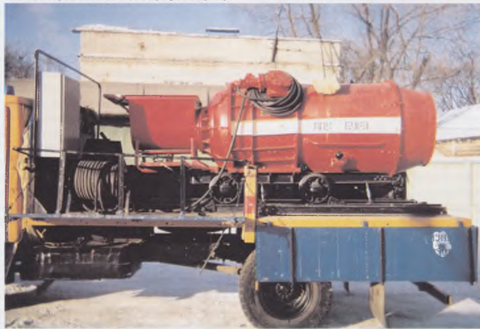
Установка порошково-пенного пожаротушения (ППУ)
