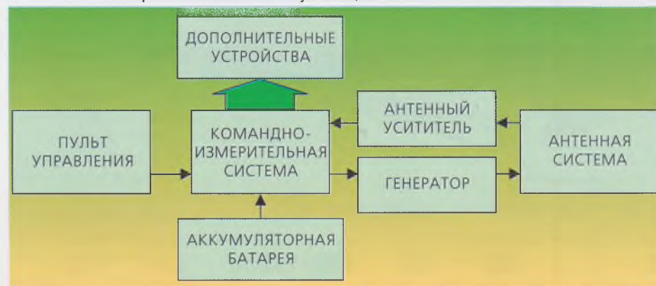
Рис. 1. Блок-схема электромагнитной системы «Импульс-авто, -сл»
