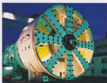
ТПМК для Лефортовского тоннеля \varnothing 14,2 м
