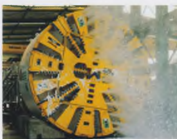
Щит с грунтопригрузом, Мадрид, Испания, \varnothing 9,33 м
