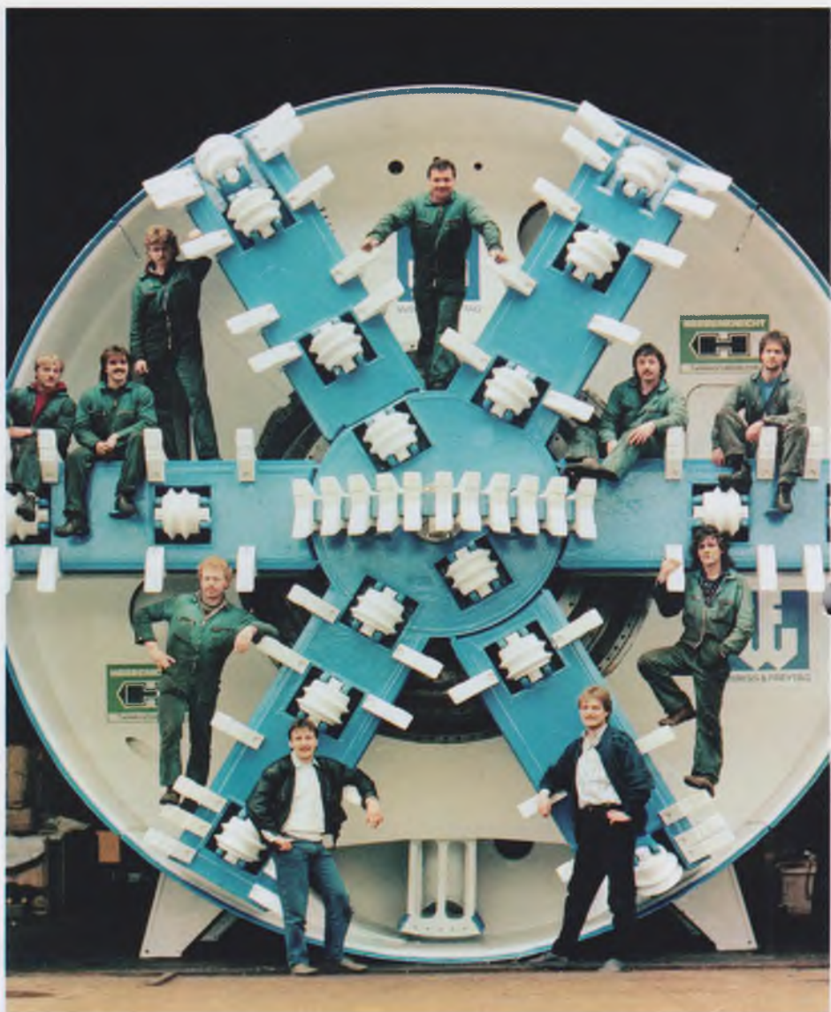
Щит фирмы «Херренкнехт АГ» с гидропригрузом забоя. Сквозь его оболочку до сих пор ходят поезда на Люблинской линии Московского метрополитена
