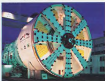
ТПК для Лефортовского тоннеля \varnothing 14,2 м
