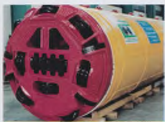
Шламная проходка в прочных породах с помощью шарошек и катковых резцов
