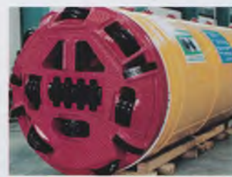
Шламная проходка в слабых грунтах с помощью лопатообразных резцов
