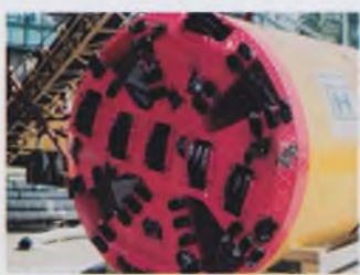
Шламная проходка в грунтах смешанного типа, с помощью шарошек и резцов
