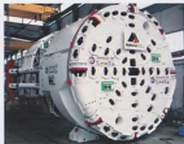
ТПК для скальных пород, Готтард, Швейцария \varnothing 8,83 м
