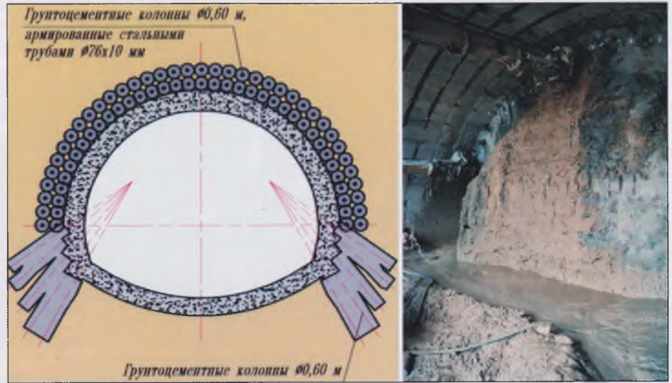
Рис. 2. Поперечное сечение и выполнение работ в зоне нахлеста грунтоцементных колонн зонтика опережающей крепи на строительстве автодорожного тоннеля «Malenchini» на автостраде Livorno-Civitavecchia
