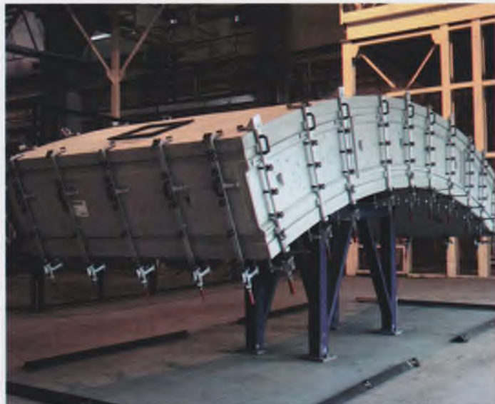
Блоки сборной высокоточной железобетонной обделки на заводе ОАО «Моспромжелезобетон»
