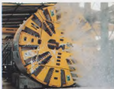
Щит с грунтопригрузом, Мадрид, Испания, \varnothing 9,33 м
