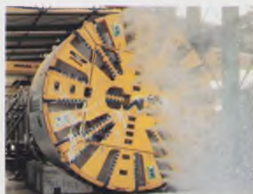
Щит с грунтопригрузом, Мадрид, Испания, \varnothing 9,33 м
