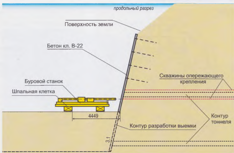
Рис. 3. Врезка тоннеля по технологии экрана из труб
