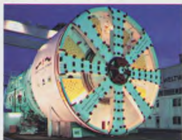
ТПМК для Лефортовского тоннеля \varnothing 14,2 м
