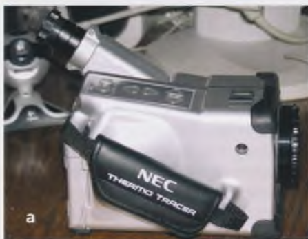
Рис. 1. Внешний вид тепловизионной камеры ТН7102: а – вид сбоку; б – вид сзади
