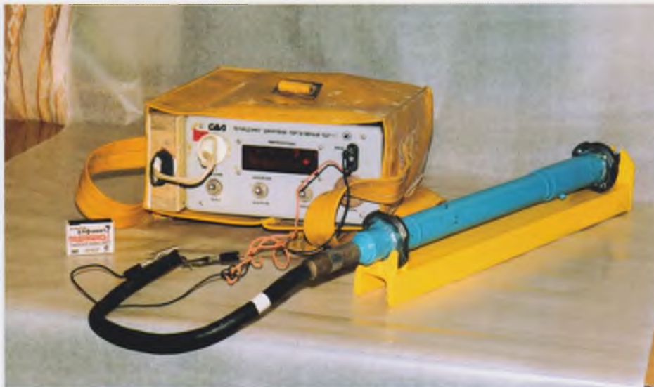
Рис. 2. Датчик ПЛДС-400, измерительная станция ПЦП-1 и стэнд для натяжения струнных датчиков
