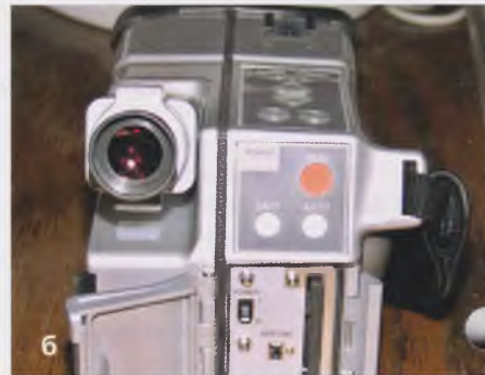
Рис. 1. Внешний вид тепловизионной камеры ТН7102: а – вид сбоку; б – вид сзади
