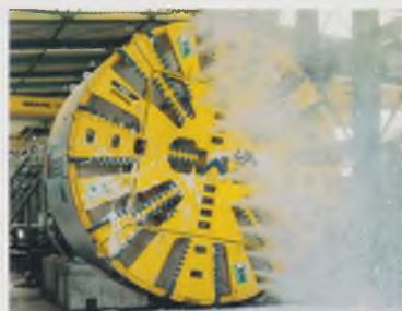
Щит с грунтопригрузом, Мадрид, Испания, \varnothing 9,33 м
