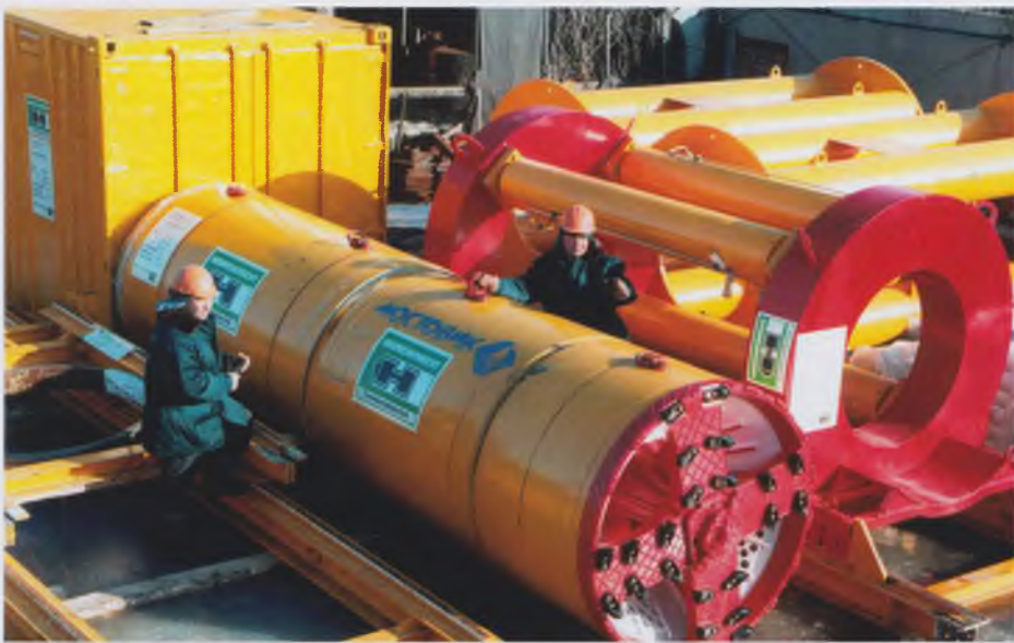
Микротоннельный щит фирмы «Херренкнехт» AVN-1200
