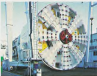
ТПМК для Лефортовского тоннеля Ø 14,2 м
