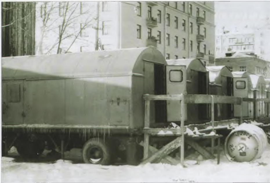
Рис. 2. Передвижные холодильные установки ПХУ-50
