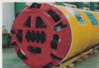
Шламовая проходка в прочных породах с помощью шарошек и катковых резцов
