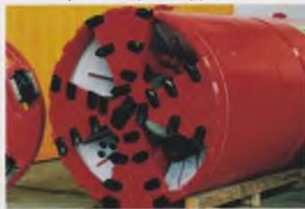
Шламовая проходка в слабых грунтах с помощью лопатообразных резцов
