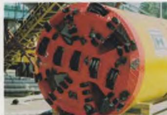
Шламовая проходка в грунтах смешанного типа с помощью шарошек и плоских (лопатообразных) резцов
