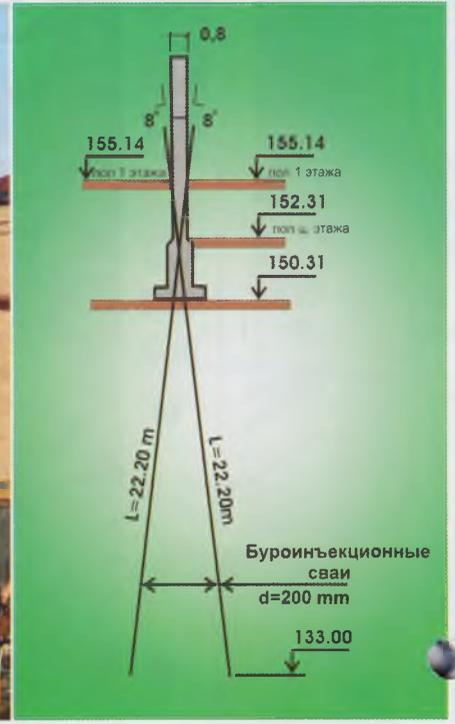
Рис. 2. Усиление фундамента старого здания театра буроинъекционными сваями
