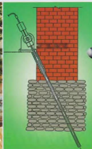
Рис. 1. Устройство скважин станком колонкового бурения
