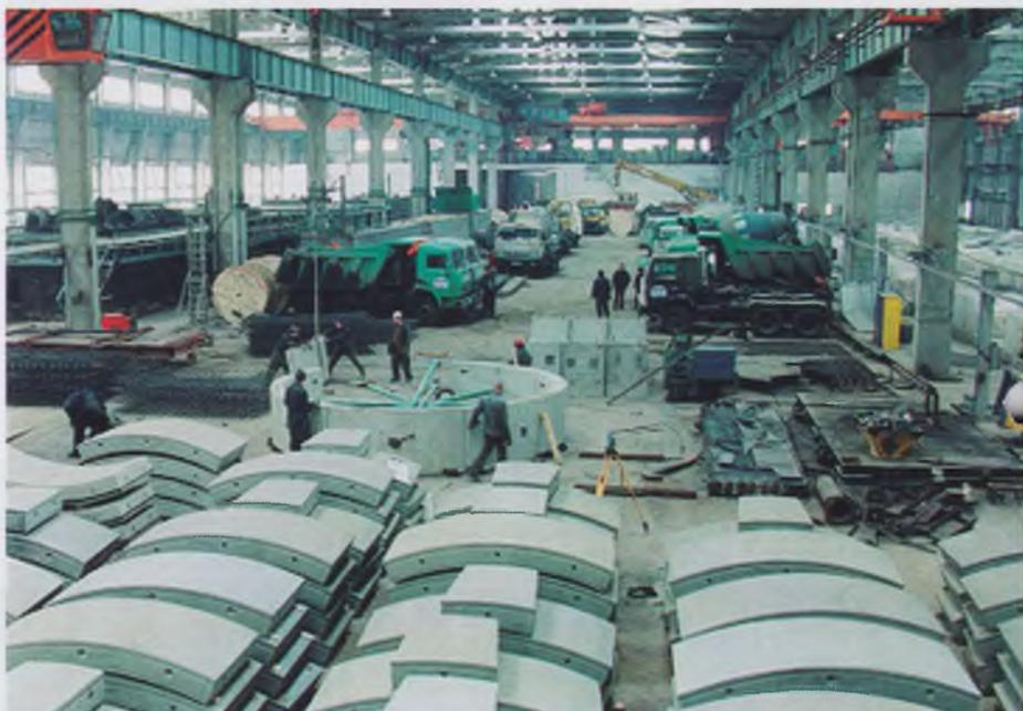
Блоки высокоточной водонепроницаемой железобетонной обделки
