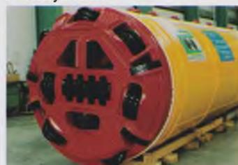
Шламная проходка в прочных породах с помощью шарошек и катковых резцов
