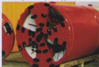
Шламная проходка в слабых грунтах с помощью лопатообразных резцов
