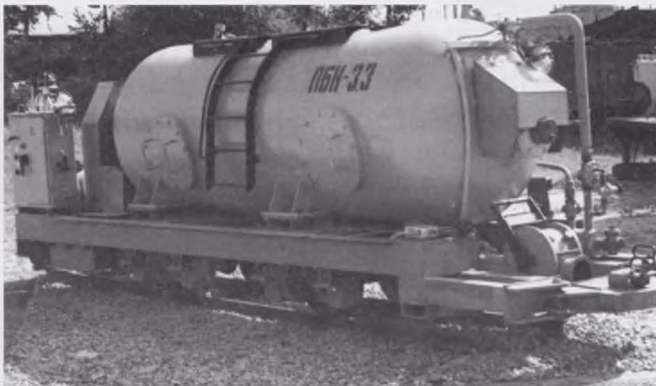
Рис. 2. Пневмобетонукладчик ПБН-3.3
