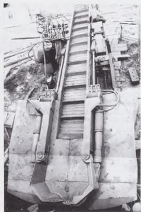
Рис. 3. Машина ТПМ-Н перед спуском в наклонный ход для испытаний
