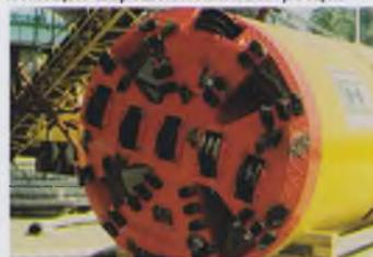
Шламная проходка в грунтах смешанного типа с помощью шарошек и плоских (лопатообразных) резцов
