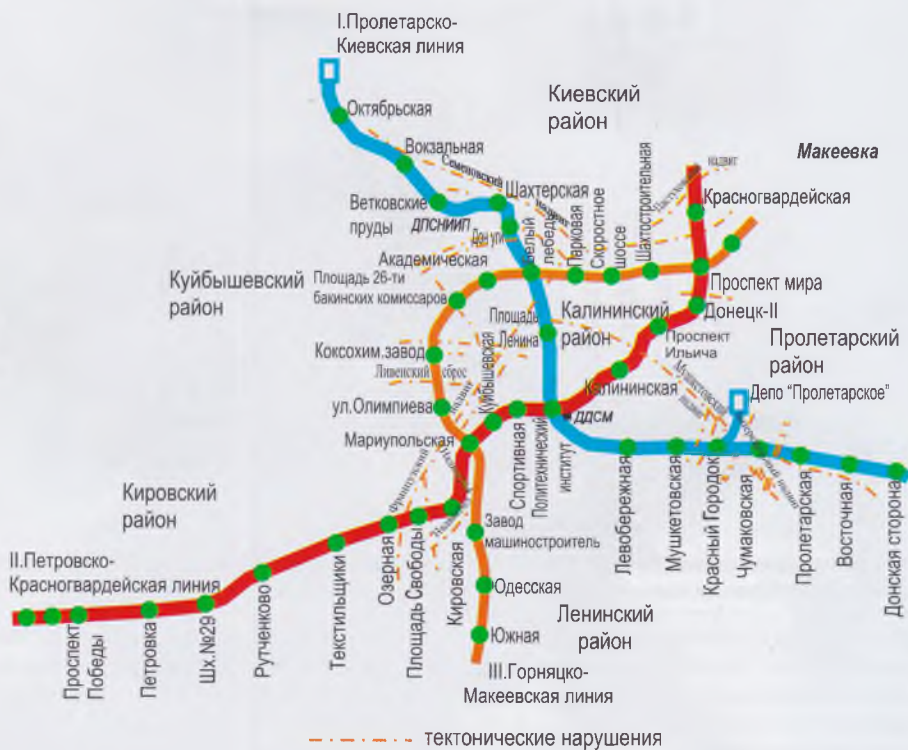
Рис. 1. Линии Донецкого метрополитена, совмещенные с выходами тектонических нарушений
